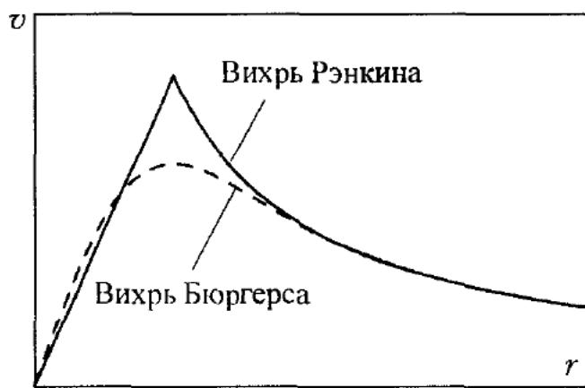
Рис. 3.19. Профили азимутальной скорости в моделях вихрей Рэнкина и Бюргерса
