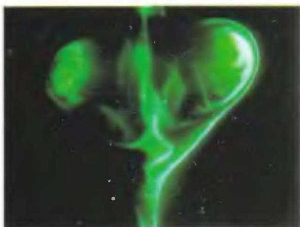
*Цв. рис. 2.* Визуализация в поперечном сечении потоков для открытого пузырькового (*а*), закрытого пузырькового (*б*) и конического (*в*) типов распада [Kho et al., 1997].
