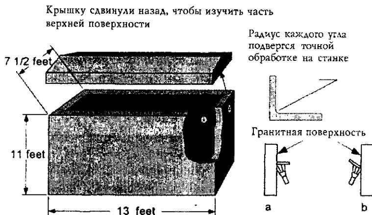
Места, проверенные при помощи 6-дюймового плоского, стального правила. На поверхности нет ни одного отклонения, она идеально ровная.
