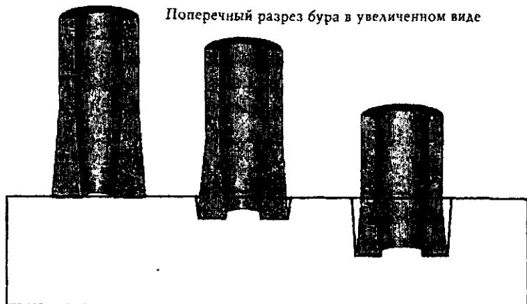
При взаимодействии инструмента с абразивной суспензией, как и с гранитом, он стирается. По мере продвижения инструмента вглубь его длина уменьшается, в результате колонка породы и отверстие приобретают коническую форму
