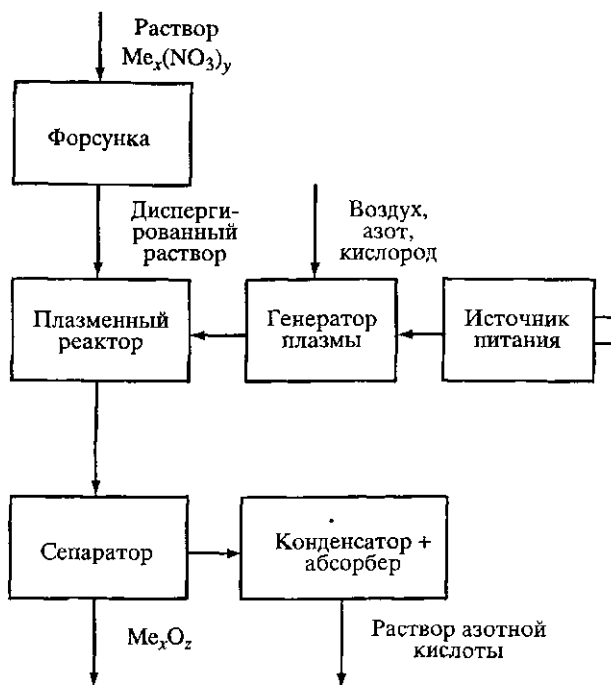
Рис. 5.12. Схема плазменного разложения азотнокислых растворов
