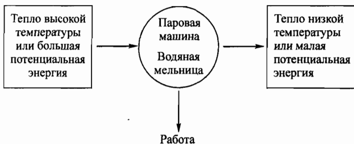
Рис. 6.1. Паровая машина или водяная мельница из одного резервуара (реки или ручья в случае мельницы) забирают высокоценную энергию (тепловую или потенциальную), производят работу и отдают во второй резервуар уже обесцененную энергию.
