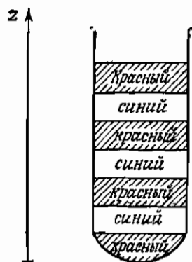
Фиг. 2.8. Спонтанные пространственные периодические структуры в системе бром-малоновая кислота — ферроин.
