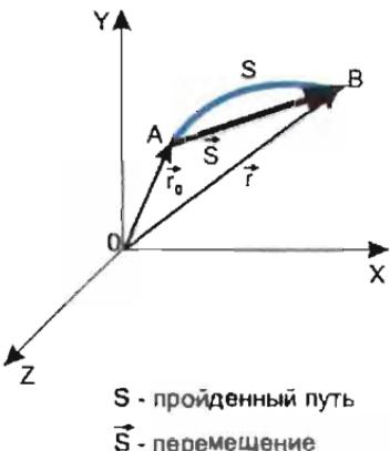
Рис. 23. Векторный способ определения положения тела
