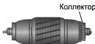
Рис. 113. Якорь двигателя постоянного тока
