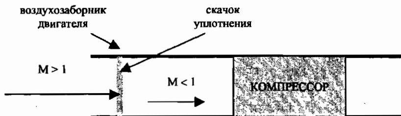
Рис. Скачок плотности в воздухозаборнике самолета летящего со сверхзвуковой скоростью.
