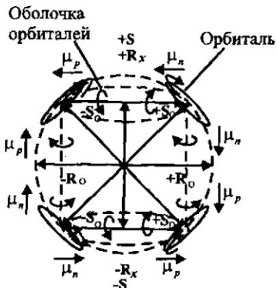
Рис. 10.3. Схема взаимодействия магнитных моментов протонов и нейтронов в спиновой паре дейтрона
