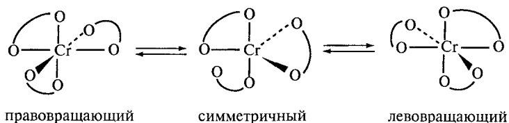
Рис. 36. Механизм рацемизации [\text{Cr}(\text{C}_2\text{O}_4)_3]^{3-} .
