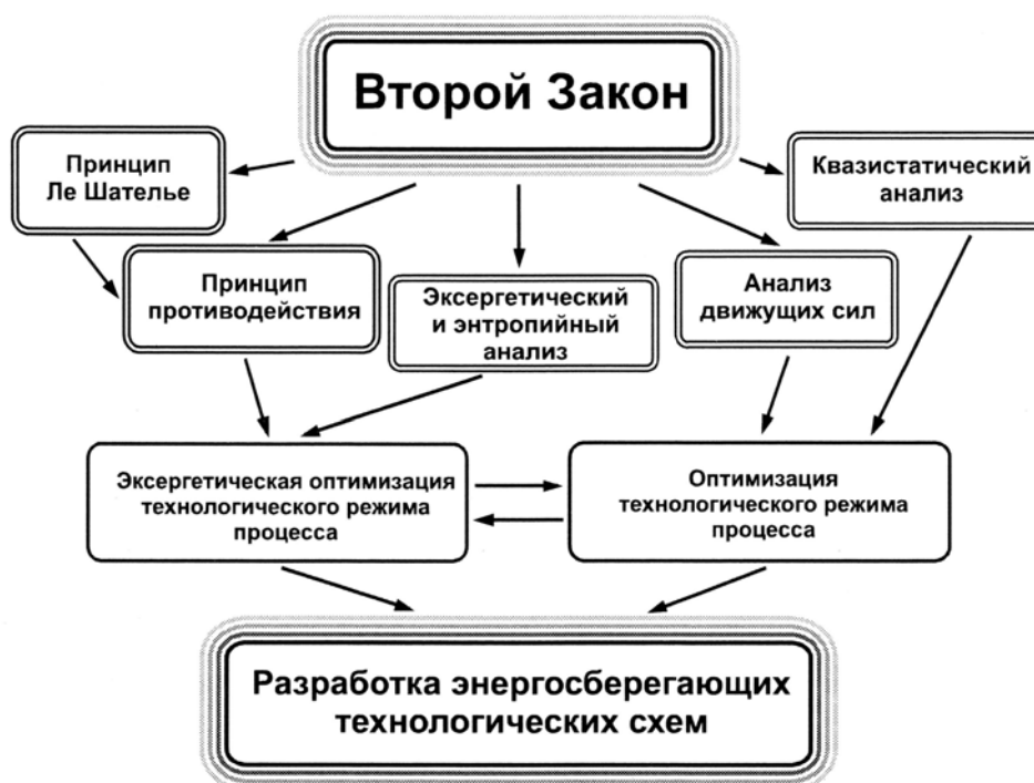
Рис. 71. Некоторые следствия из Второго Закона и основанные на них методы анализа технических процессов
