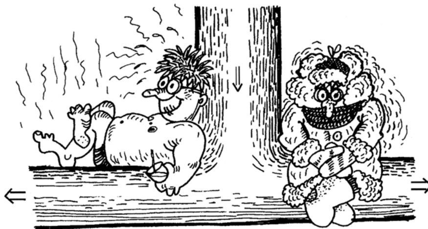
Рис. 15. Вихревая труба Д.Ранка в воображении художника. Газ, входящий сверху по трубе, расслаивается на левый — горячий — поток и правый — холодный поток. Внутри трубы имеется не показанное художником сопло, перпендикулярное оси трубы, через которое со звуковой или сверхзвуковой скоростью входит газ
