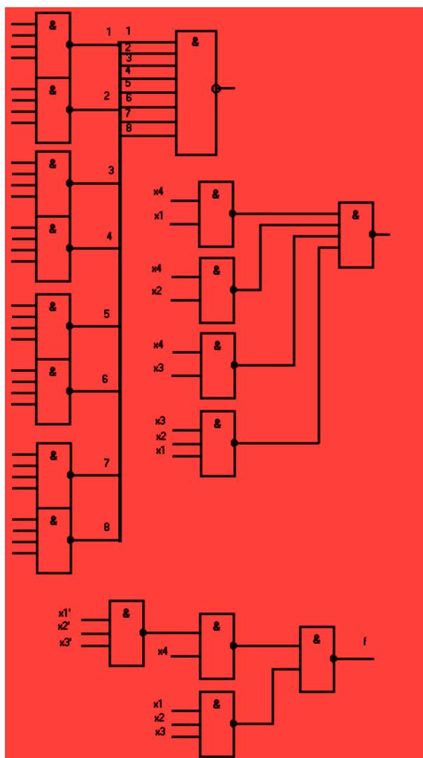
**Схема автомата до и после минимизации.**
