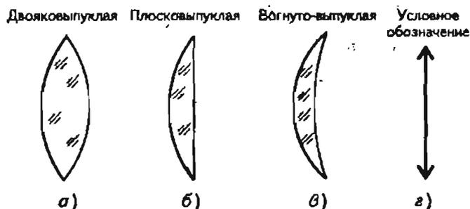
Рис. 10. Внешний вид и условное обозначение собирающей линзы
