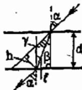
По закону преломления света  $\sin\alpha/\sin\beta = n$ ,  $\sin\alpha = nsin\beta$ .Из рисунка видно, что  $\gamma = \alpha - \beta$ ,  $l = d/\cos\beta$ ,  $h = lsin\gamma$ .
