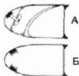
Так располагают индукторы ЭИПОС на носках крыла (А) и стабилизатора (Б) самолета.
