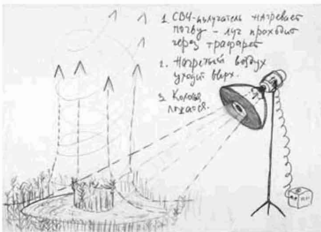
Примерно так можно изобразить процесс получения «пиктограммы» с помощью дистанционного нагрева почвы СВЧ-излучателем.
