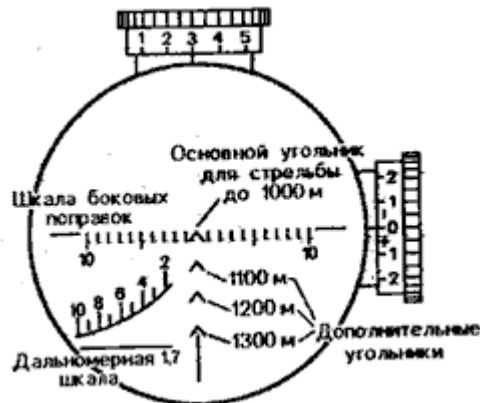
Схема 20. Сетка прицела ПСО-1, установленного на снайперской винтовке СВД
