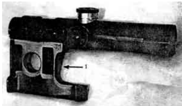
Фото 92. Оптический прицел ПУ (прицел универсальный): 1 - кронштейн прицела
