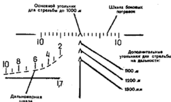
Схема 13. Сетка прицела ПСО-1, установленного на винтовке СВД
