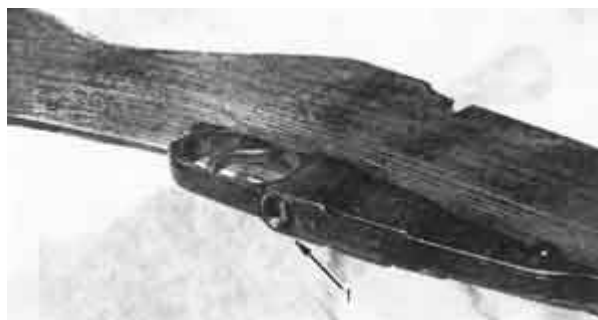
Фото 13. Неполная разборка. Подать назад защелку магазинной коробки (1)
