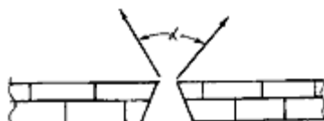
Схема 106. Амбатура "обратный раструб"; \alpha - сектор обстрела
