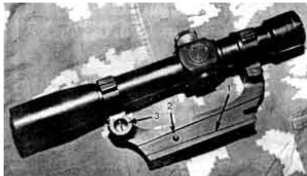
Фото 91. "Косой" "ласточкин хвост" 1 для крепления кронштейна на таком же "косом" основании
