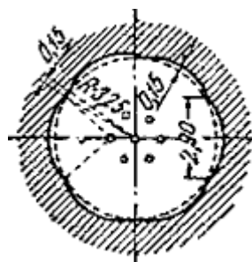
Схема 138. Нарезы 6,5-мм винтовки системы Арисака
