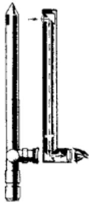
Схема 103. Ручной перископ применяется для наблюдения из-за укрытия. Стрелками показан ход лучей в перископе.
