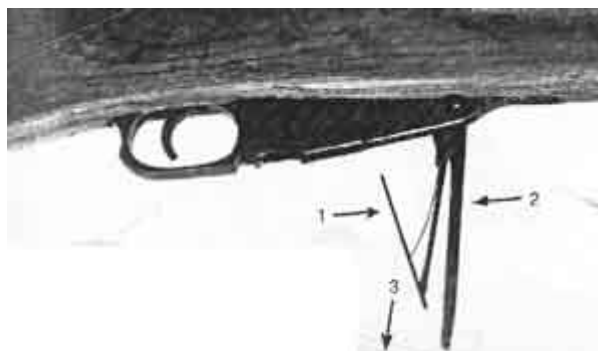
Фото 15. Неполная разборка. Подаватель 1 и крышку магазинной коробки 2 прижать друг к другу, подающий узел извлечь в направлении стрелки 3
