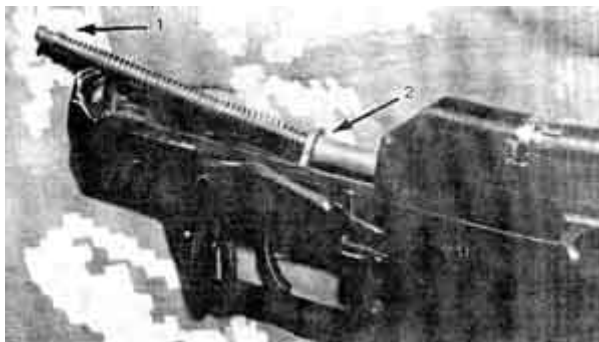
Фото 74. Разборка "Винтореза": - отделить боевую пружину 1; - отделить ударник 2
