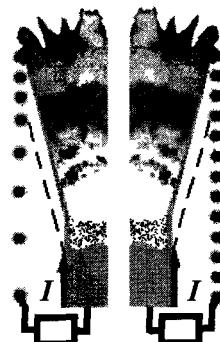
**Рис. 2.19.** Схема работы СВМГ с обмоткой, намотанной с постоянным шагом витков (справа), и с обмоткой, шаг витков которой увеличивается по мере приближения точки контакта к нагрузке
