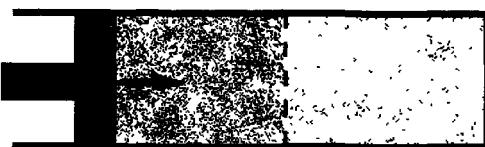
**Рис. 2.6.** Образование ударной волны поршнем, вдвигаемым в цилиндр с газом
