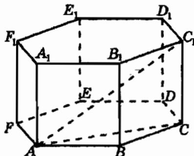
27. Достроим призму, присоединив к ней правильную треугольную призму  $ABG A_1 B_1 G_1$ . Искомым расстоянием является длина отрезка  $AH_1$ , где  $H_1$  – середина ребра  $B_1 G_1$ . В прямоугольном треугольнике  $AHH_1$  имеем:  $HH_1 = 1$ ,  $AH = \frac{\sqrt{3}}{2}$ .
