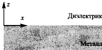
Рис. 2.2. Геометрия распространения ППП вдоль одиночной границы раздела между металлом и диэлектриком
