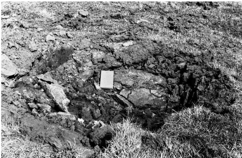
Рис. 35. Куски мерзлого грунта, взрезавшиеся в почву после падения и полностью разрушившиеся (архив автора)
