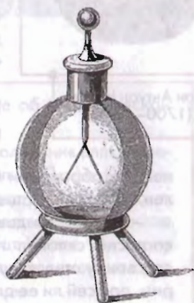
Один из первых электроскопов с золотыми листочками, изобретенный Дюфе
