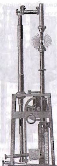
Дуговая лампа французского изобретателя Жаспара с автоматической регулировкой расстояния между стержнями
