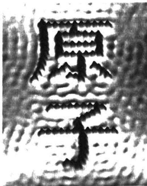
Рис. 4.7. Сочетание двух японских иероглифов (гэнси, то есть «атом»), построенное на кристаллической поверхности манипуляцией отдельными атомами
