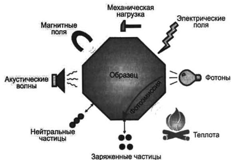
Рис. 6.1. Основа любого анализа — реакция образца на внешние воздействия в виде освещения, магнитных полей, механических нагрузок и т. п. Реакция выражается в изменении свойств, излучении фотонов (электромагнитных волн), изменении температуры и т. п. Выбранная комбинация регистрируемых реакций образца на внешние воздействия определяет выбор соответствующего аналитического метода
