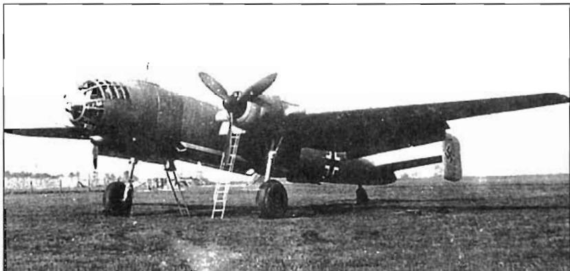
Обилие электрооборудования приводило к постоянному выходу из строя многих электродвигателей, необходимых для управления закрылками и рулями, и все это превращало полеты Fw 191 в проблему. Находившиеся в стадии постройки образцы Fw 191 V3, V4 и V5 так и не были изготовлены, и лишь на Fw 191 V6 техническое ведомство позволило использовать гидравлику.
