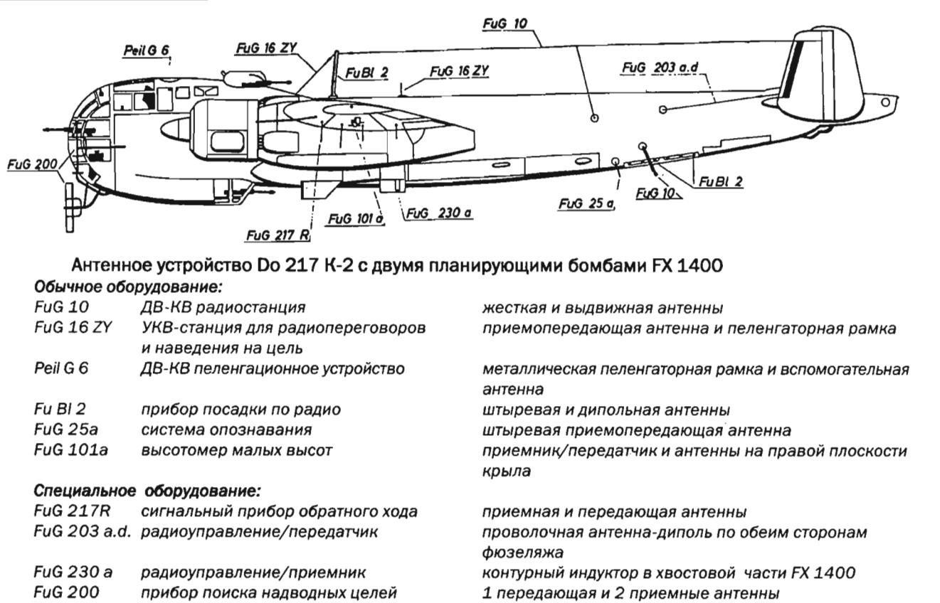
Самолет-носитель Дорнье Do 217 K-2 с авиабомбами PC 1400 X и антенным устройством управления.
