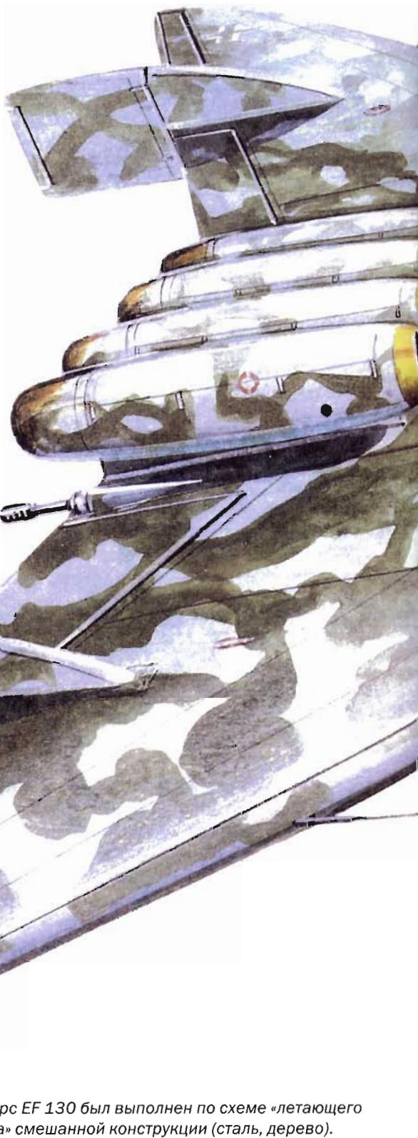
Юнкерс EF 130 был выполнен по схеме «летающего крыла» смешанной конструкции (сталь, дерево).
