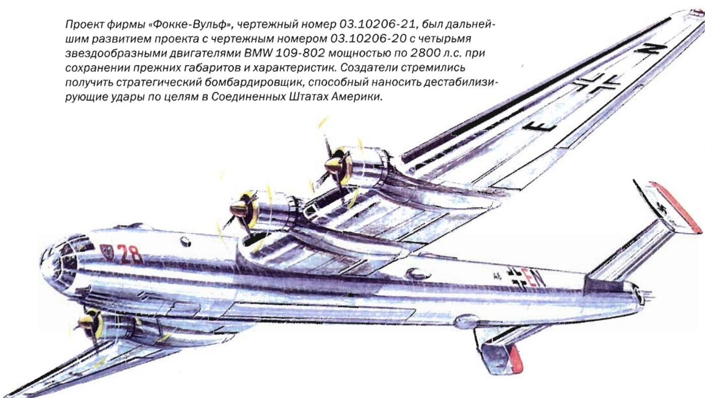
модификация А с четырьмя 28-цилиндровыми звездообразными двигателями BMW 109-803 мощностью по 4000 л.с.;
