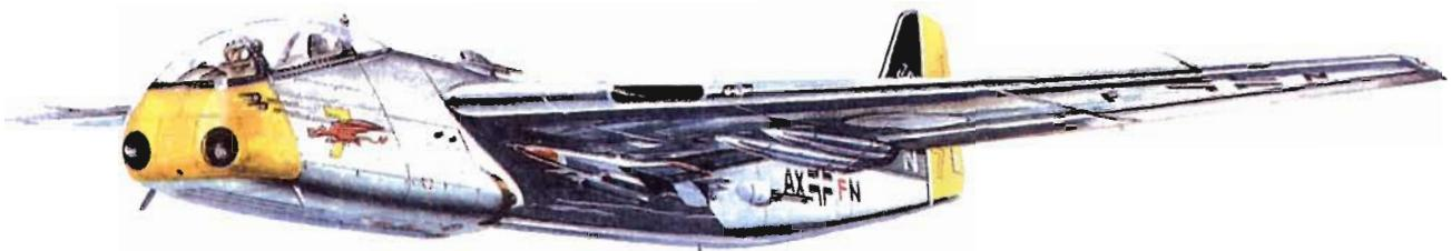
Два турбовинтовых двигателя BMW 109-028 мощностью по 6570 л.с. и дополнительной тягой по 600 кгс должны были обеспечить бомбардировщику Проект II скорость в пределах 870 км/ч. Оба турбовинтовых двигателя монтировались на двух выносных кронштейнах, расположенных под углом 45°, для того чтобы таким образом вывести рули поворота и высоты из зоны действия реактивной струи и турбулентного воздушного потока от винтов.
