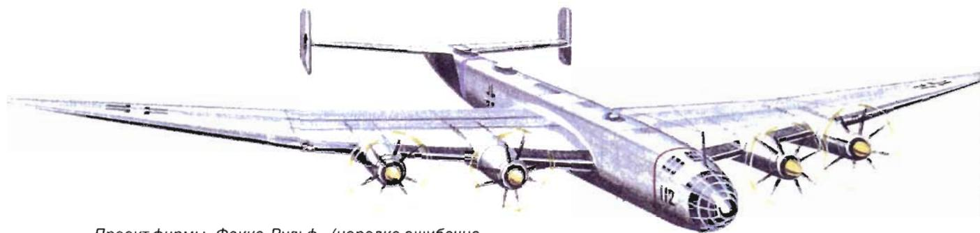
Проект фирмы «Фокке-Вульф» (нередко ошибочно обозначаемый FW 238), чертежный номер 03.10206-20, модификация А с четырьмя 28-цилиндровыми звездообразными двигателями BMW 109-803.
