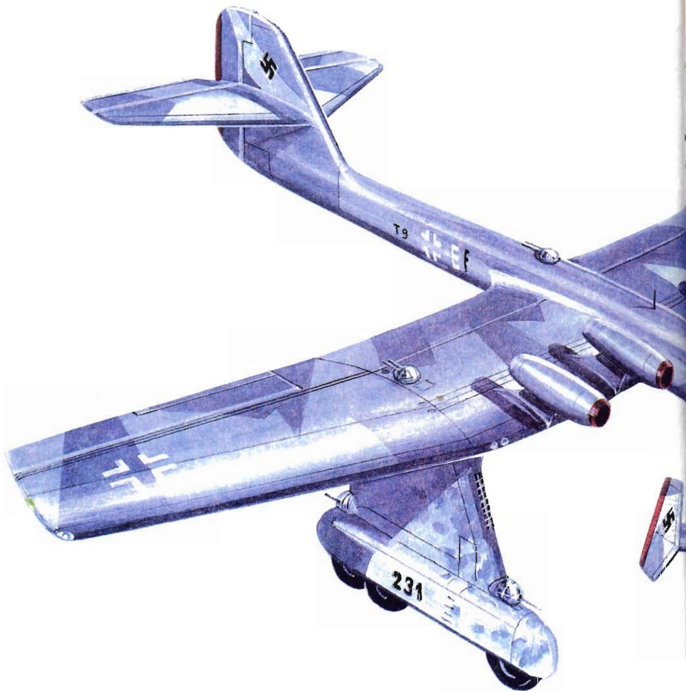
Проект А фирмы «Даймлер Бенц» – самолет-носитель, имевший под фюзеляжем между удлиненными стойками шасси реактивный бомбардировщик – последний предполагалось транспортировать в район боевых действий.
