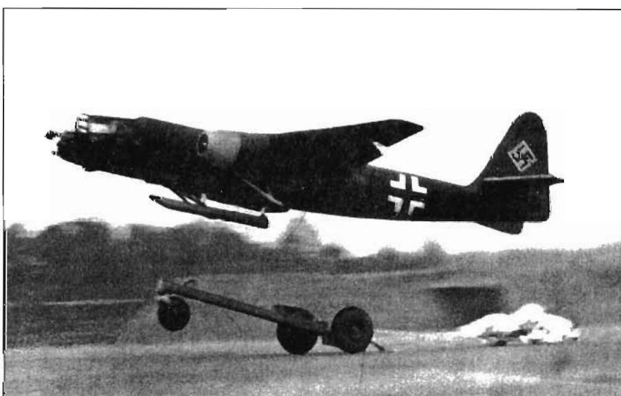
Арадо Ar 234 A на взлете в момент отделения стартовой тележки. Стартовая тележка падает на землю и затормаживается при помощи тормозного парашюта.
