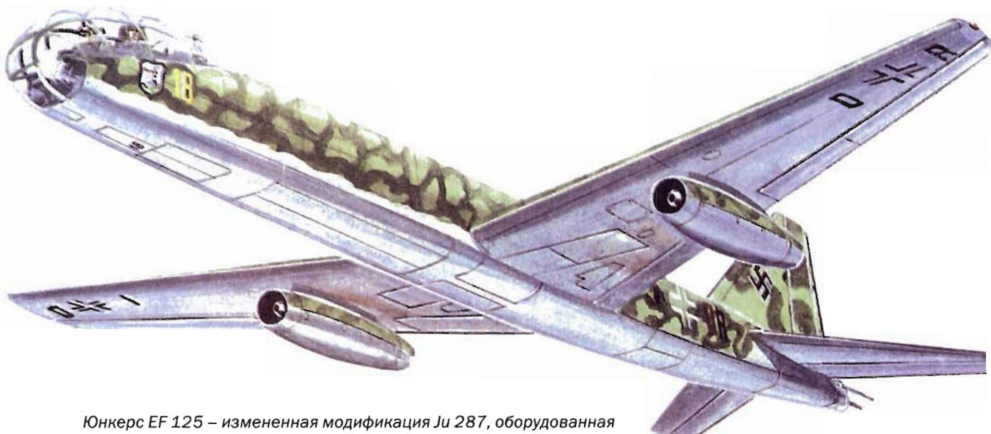
Юнкерс EF 125 – измененная модификация Ju 287, оборудованная только двумя мощными реактивными двигателями BMW 109-018.
