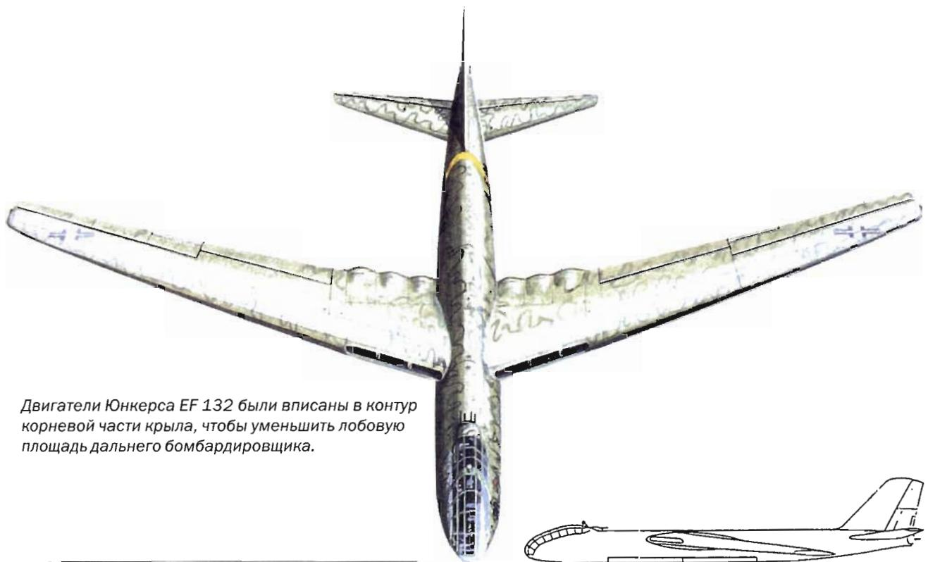
Двигатели Юнкерса EF 132 были вписаны в контур корневой части крыла, чтобы уменьшить лобовую площадь дальнего бомбардировщика.
