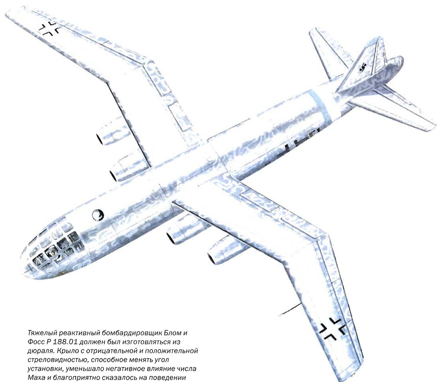
Тяжелый реактивный бомбардировщик Блом и Фосс Р 188.01 должен был изготавляться из дюраля. Крыло с отрицательной и положительной стреловидностью, способное менять угол установки, уменьшало негативное влияние числа Маха и благоприятно сказалось на поведении машины при вибронагрузках в полете.
