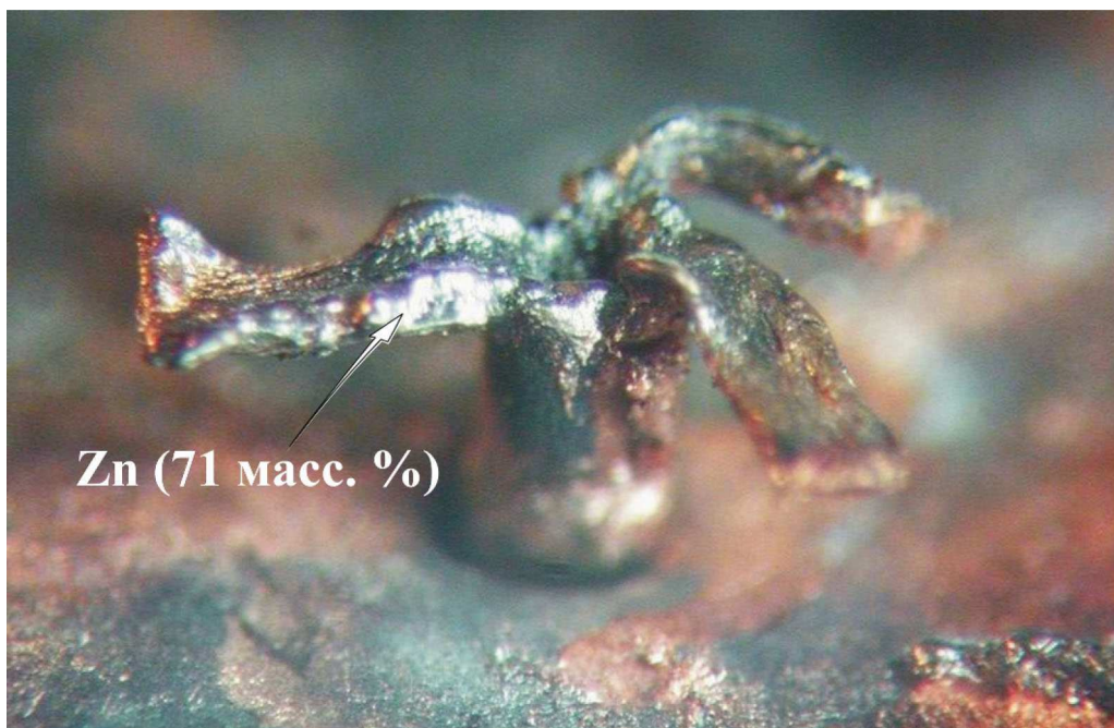
Рис. 7-2. Медная мишень после эксперимента со следами застывшей серебристо-белой «лавы» на её лепестках, вылившейся из центра взорвавшейся мишени (иллюстрация из [Адаменко 2004]).
