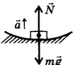
Силы, действующие на автомобиль вдоль радиуса моста изображены на рисунке:  $N$  — сила реакции моста,  $mg$  — сила тяжести. Согласно второму закону
