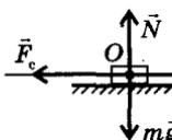
Запишем второй закон Ньютона в проекциях сил на ось  $Ox$ :  $F_{tx} - F_{cx} = ma_x$ . Так как при
