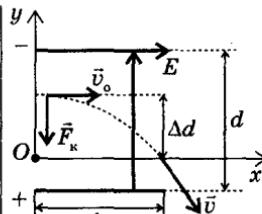
Запишем второй закон Ньютона:  $\vec{F}_K = m_e \vec{a}$  (силой тяжести можно пренебречь). В проекции на ось  $OY$ :  $F_K = m_e a_y$ , где  $F_K = q_e E = q_e \frac{U}{d}$ ;  $a_y = \frac{q_e U}{dm_e}$ .
