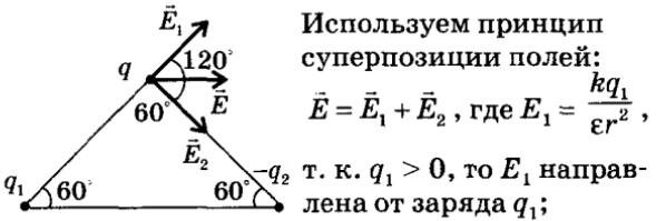
$E_2 = \frac{kq_2}{\epsilon r^2}$ , т. к.  $q_2 < 0$ , то  $E_2$  направлено к заряду  $q_2$ . Из рисунка видно, что угол между  $E_1$  и  $E_2$  равен  $120^\circ$ . Применив теорему косинусов, получим:  $E = \sqrt{E_1^2 + E_2^2 - 2E_1 E_2 \cos 120^\circ} = \sqrt{E_1^2 + E_2^2 + E_1 E_2}$ ;
