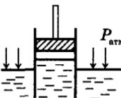
Простейшая модель всасывающего насоса показана на рисунке. При поднятии поршня между ним и поверхностью жидкости образуется разрежение и вода начинает подниматься под действием атмосферного давления  $p_{\text{атм}}.$
