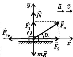
Рассмотрим перемещение груза равномерно по поверхности. Составим систему уравнений в проекциях всех сил на ось  $OX$  и  $OY$  по второму закону Ньютона.
