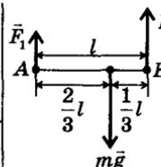
Так как при равновесии твердого тела сумма моментов всех внешних сил, действующих на него относительно любой оси, равна нулю, то выберем оси вращения в точках A и B. Запишем второе условие равновесия твердого тела:
