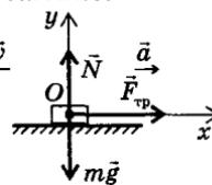
Направим ось  $OX$  против движения тела с началом оси в центре тяжести тела. В этом направлении действует только одна сила  $\vec{F}_{\text{tp}}$ , которая по второму закону
