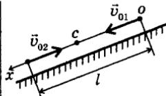
Совместим начало координат с положением первого мотоциклиста в начальный момент времени. Тогда движения мотоциклистов будут описываться кинематическими уравнениями:  $x_1 = v_{01}t + \frac{at^2}{2}$ ;  $x_2 = l - v_{02}t - \frac{(-a)t^2}{2} = l - v_{02}t + \frac{at^2}{2}$ . Так как в момент встречи координата и время для обоих мотоциклистов одинаковы, то можно приравнять правые части этих уравнений.  $v_{01}t + \frac{at^2}{2} = l - v_{02}t + \frac{at^2}{2}$ ;
