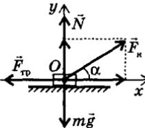
$A = F|\Delta\vec{r}|\cos\alpha$ , где  $F = F_n$ ,  $|\Delta\vec{r}| = S$ ;  $A = F_n S \cos\alpha$ . Для определения  $F_n$  используем второй закон Ньютона. Составим и решим систему уравнений проекций сил на ось  $OX$  и  $OY$ .
