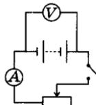
При разомкнутом ключе ЭДС источника тока равна напряжению на внешней цепи. Так как сопротивление источника тока обычно мало, то  $R_B \gg r$ . При этом отличие  $E$  от  $U$  не превышает десятых долей процента, поэтому погрешность измерения ЭДС равна погрешности измерения напряжения.
