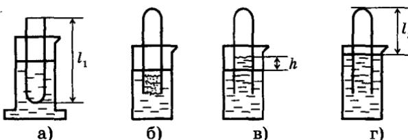
При этом объем воздуха  $V$ , равен объему стеклянной трубки, а температура — температуре горячей воды  $T$ . Это первое состояние. Чтобы масса воздуха осталась постоянной, открытый конец стеклянной трубки, находящийся в горячей воде, замазываем пластилином. Через 3–5 мин трубку вынимаем из сосуда с горячей водой и быстро опускаем в стакан комнатной температуры (рис. б) и под водой снимаем пластилин. После прекращения подъема воды в трубке объем воздуха станет равным  $V_2 < V_1$ , а давление
