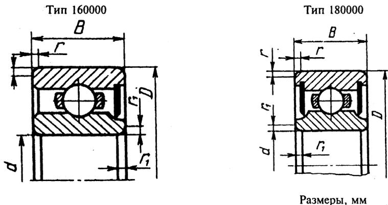
Подшипники типа 160000 допускается изготавливать с кольцами от подшипников типа 180000.
