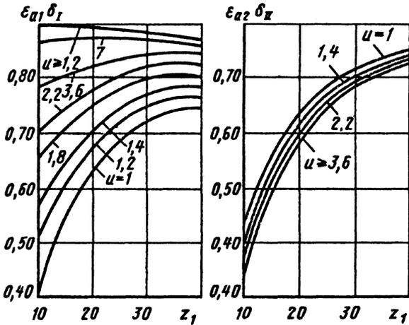
Рис. 59. График для определения значений  $\epsilon_{\alpha 1} \delta_I$  и  $\epsilon_{\alpha 2} \delta_{II}$  для косозубых передач без смещения при  $15^\circ \leq \beta \leq 27^\circ$
