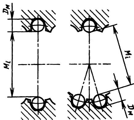
Рис. 20. Размер между роликами
