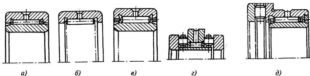
Рис. 17. Подшипники радиальные роликовые игольчатые или роликовые с длинными цилиндрическими роликами исполнений:
