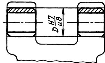
Рис. 11. Пример применения втулок без буртика
