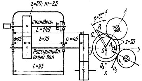
**Рис. 13.** Схема передачи к примеру для расчета
