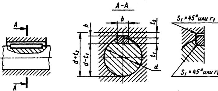
На рабочем чертеже должен проставляться один размер для вала  $t_1$  (предпочтительный вариант) или  $d-t_1$  и для втулки  $d+t_2$
