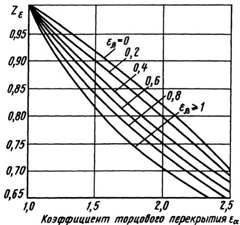
Рис. 44. График для определения коэффициента  $Z_\epsilon$
