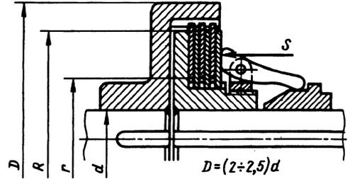
**Рис. 1. Узел ненормализованных фрикционных многодисковых муфт трения**
