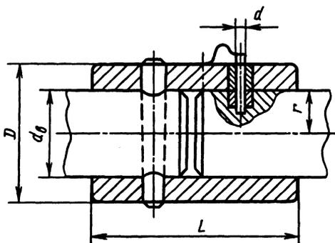
Рис. 7. Предохранительная втулочная муфта со срезным штифтом
