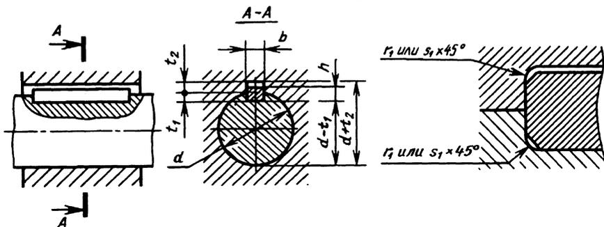
Вместо контроля размеров  $t_1$  и  $t_2$  допускается контролировать размеры  $(d - t_1)$  и  $(d + t_2)$ , предельные отклонения которых должны соответствовать указанным в табл. 3.
