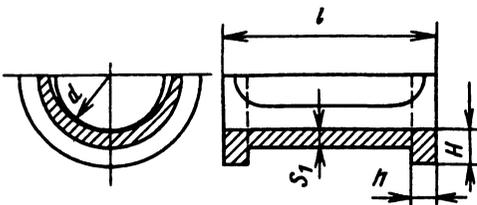
Рис. 2. Конструктивные размеры вкладыша
