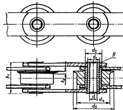
1 — валик; 2 — втулка; 3 — каток с ребордой; 4 — внутренняя пластина; 5 — наружная пластина;
