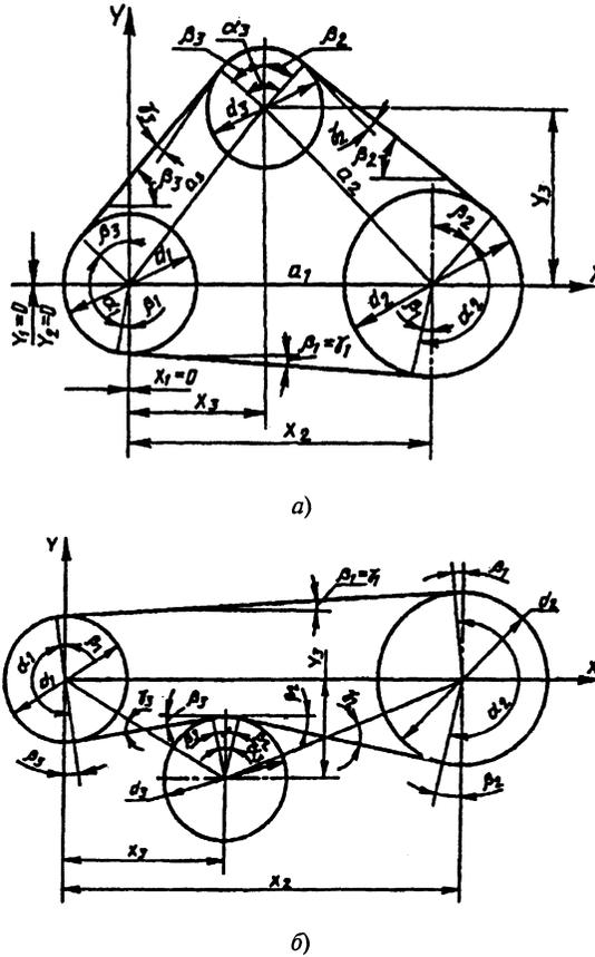
Рис. 13. Схемы расчета трехшкивных передач
