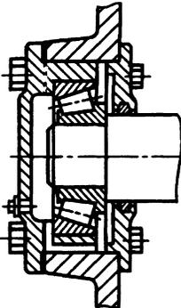
Конический роликоподшипник в глухой крышке, имеющей удлиненную центрирующую часть
