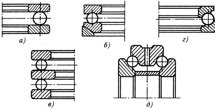
Рис. 20. Подшипники упорные и упорно-радиальные шариковые исполнений:
