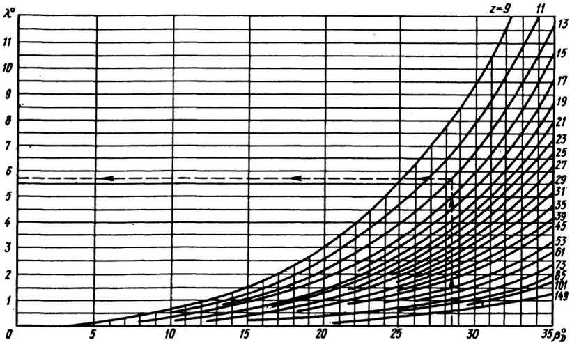
Рис. 16. График для определения величины  $\lambda$  в зависимости от  $z$  и  $\beta_D$
