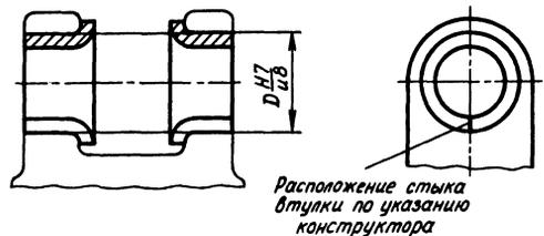
Рис. 12. Пример применения втулок с буртиком
