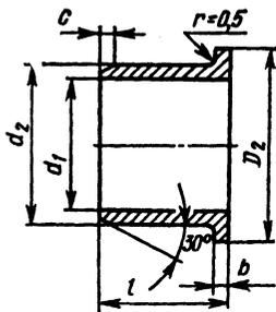
Отверстие стальной обоймы (детали) выполняются по посадке Н7 (ГОСТ 25346-89), шероховатость его поверхности не выше  $Rz\ 20\ \mu\text{м}$ .
