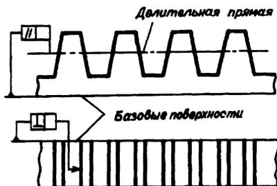
Рис. 27. Базовые поверхности рейки
