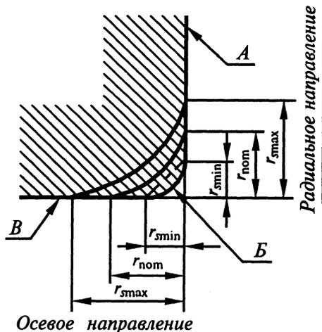
Рис. 44. Размеры монтажных фасок колец подшипников
