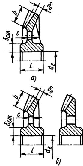
**Рис. 41. Конструкции конических колес:**
