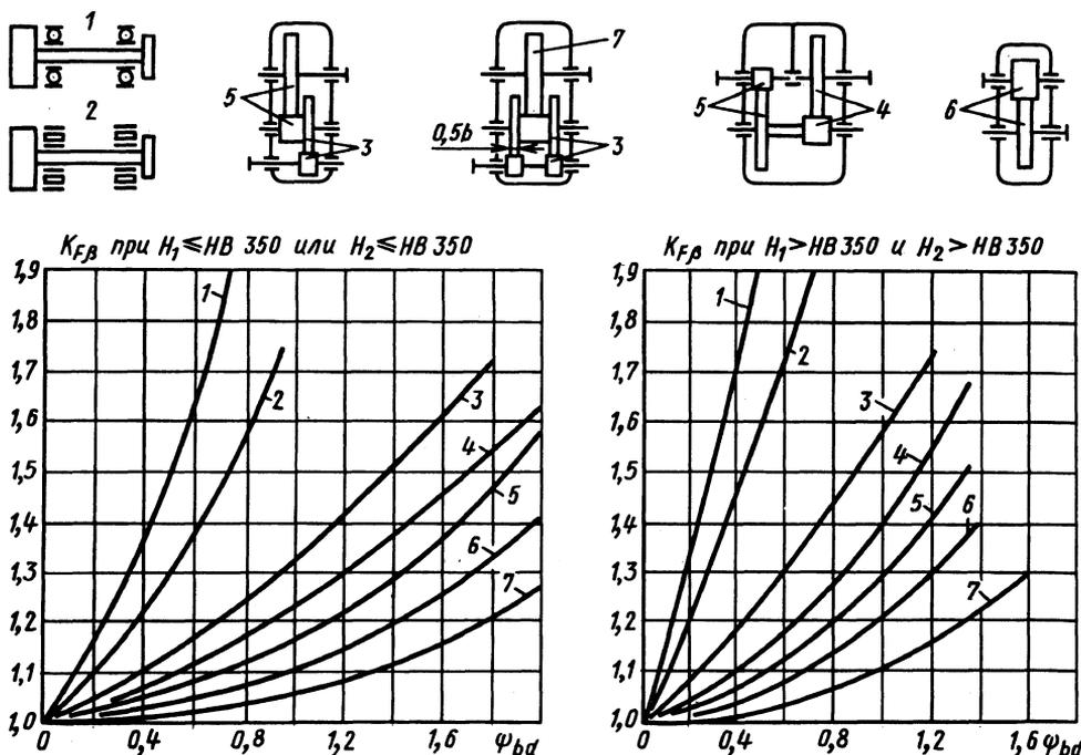
Рис. 57. График для определения ориентировочных значений коэффициента  $K_{F\beta}$ .
