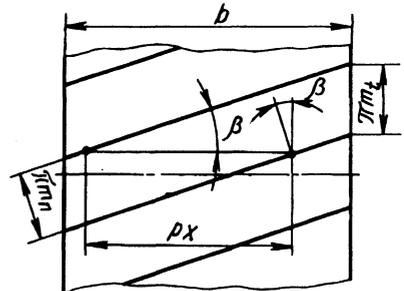
Рис. 12. Схема развертки делительного цилиндра косозубого колеса
