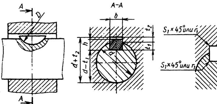
В зависимости от принятой базы обработки и измерения на рабочем чертеже должен указываться один размер для вала  $t_1$  (предпочтительный вариант) или  $d - t_1$  и для втулки  $d' + t_2$ .
