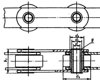
1 — валик; 2 — втулка; 3 — каток; 4 — внутренняя пластина; 5 — наружная пластина;
