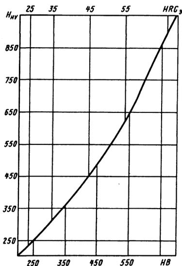
Рис. 50. График соотношений твердостей, выраженных в единицах  $HV$ ,  $HRC$  и  $HV$
