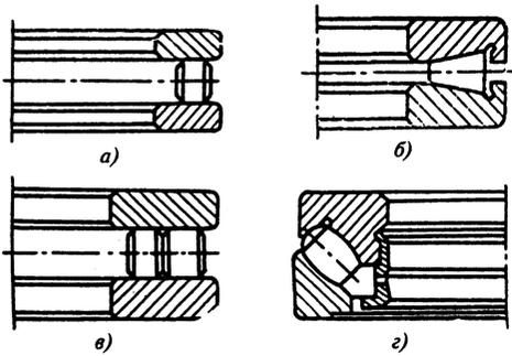
**Рис. 21. Подшипники упорные и упорно-радиальные роликовые исполнений:**
