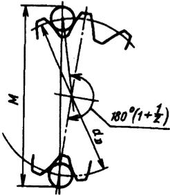
← Рис. 14. Размеры по роликам при нечетном числе зубьев
