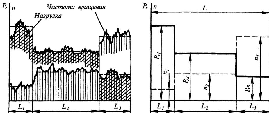
Рис. 27. Аппроксимация нагрузок и частот вращения
