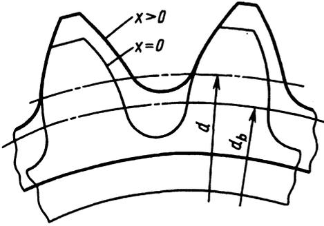
Рис. 8. Влияние смещения исходного контура на геометрию зубьев
