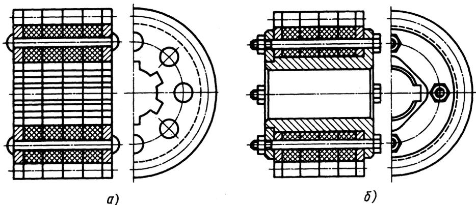
Рис. 24. Конструкция армированных зубчатых колес:
