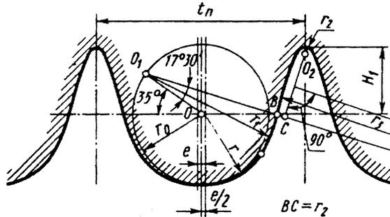
Расчет и построение профиля основной рейки в нормальном сечении при изготовлении зубьев звездочки методом обкатки по диаметру делительной окружности  $d_d$  даны в таблице и на рисунке. Центр дуги радиуса  $r_3$  лежит на пересечении перпендикуляра, восстановленного из середины отрезка  $O_2C$ , с продолжением линии  $O_1BC$ .
