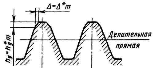
Рис. 2. Исходный контур с профильной модификацией
