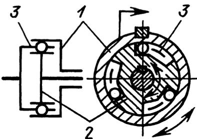
Рис. 3. Муфты, передающие медленное вращение в одном направлении и ускоренное вращение в двух направлениях:
