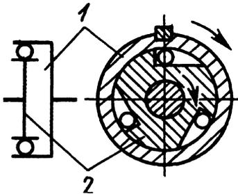
Рис. 2. Муфты, передающие вращение в одном направлении
