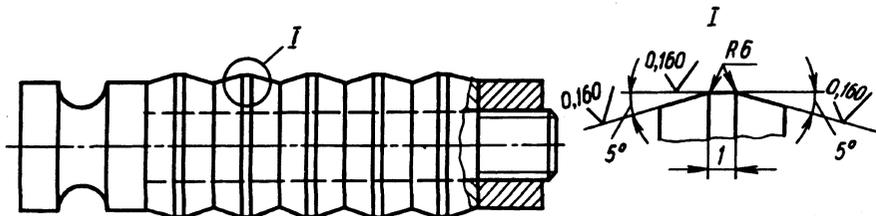
Рис. 8. Рекомендуемая форма разглаживающей протяжки
