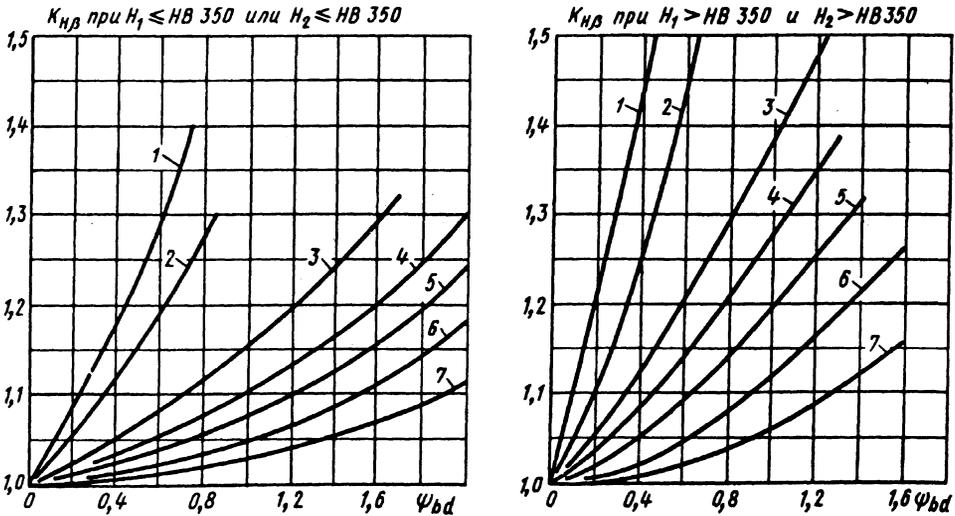
Рис. 56. График для определения ориентировочных значений коэффициента  $K_{FB}$ .
