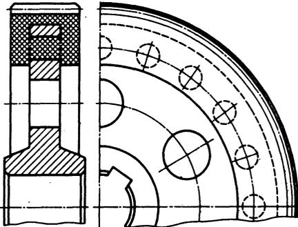
Рис. 26. Армированное зубчатое колесо из термопласта
