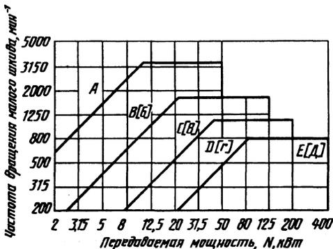
Рис. 11. График для определения сечения ремня
