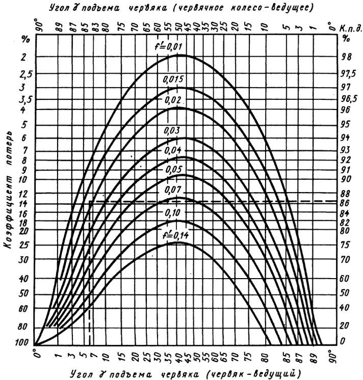
Рис. 70. График для определения КПД червячных передач
