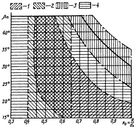
**Рис. 36. Области рационального применения осевых форм зубьев I, II, III (исходный контур по ГОСТ 16202—81):**
