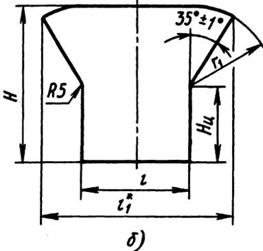
Рис. 10. Развертка заготовки втулки с буртиком:
