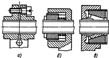
**Рис. 3. Способы устранения зазоров:**
