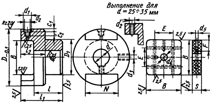
Материал — сталь Ст3 для полумуфт с  $d \leq 45$  мм; чугун СЧ 10 для полумуфт с  $d > 45$  мм; текстолит поделочный для призматической детали.
