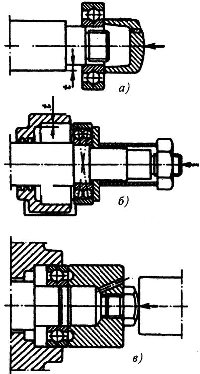
Рис. 39. Установка подшипников на вал (а), в корпус (б), одновременно на вал и в корпус (в)
