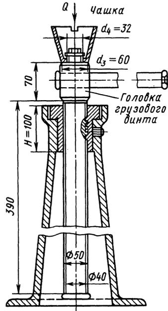
Рис. 4. Схема к расчету домкрата
