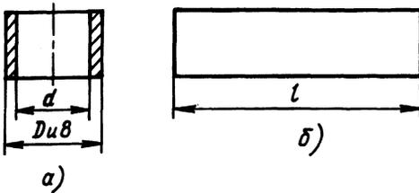
Рис. 9. Развертка заготовки втулки без буртика:
