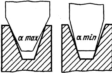
Рис. 8. Положение предельного углового калибра в канавке шкива
