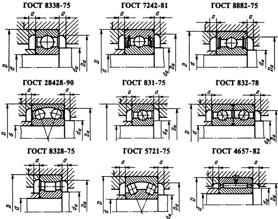
Шариковые подшипники серии диаметров 8, серии по ширине 1 по ГОСТ 8338-75.
