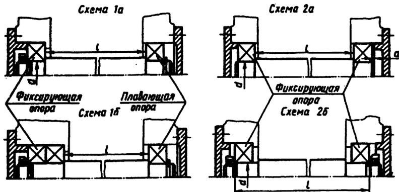
Рис. 24. Способы осевого фиксирования валов
