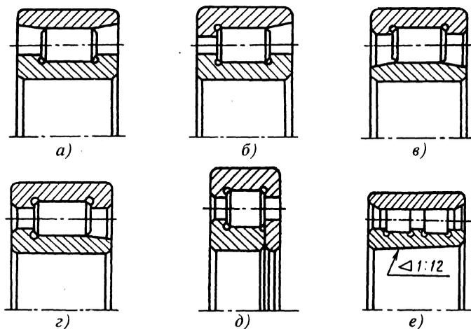
**Рис. 15. Подшипники радиальные роликовые с короткими цилиндрическими роликами исполнений:**
