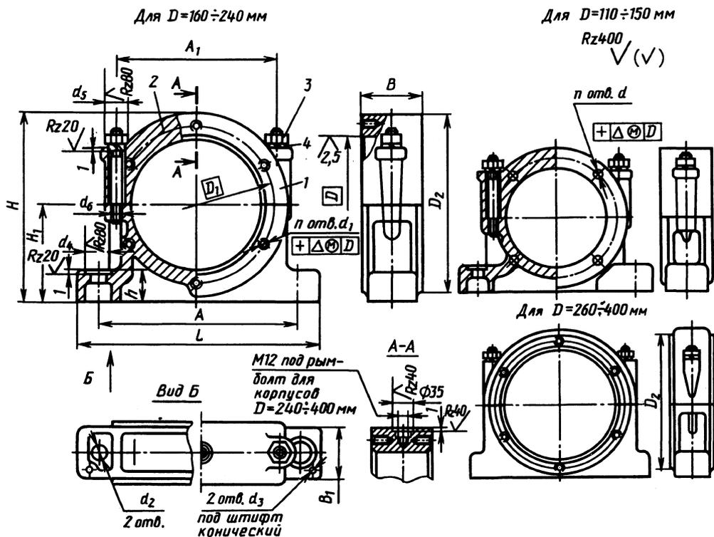
1 — основание корпуса; 2 — крышка; 3 — гайка; 4 — шайба
