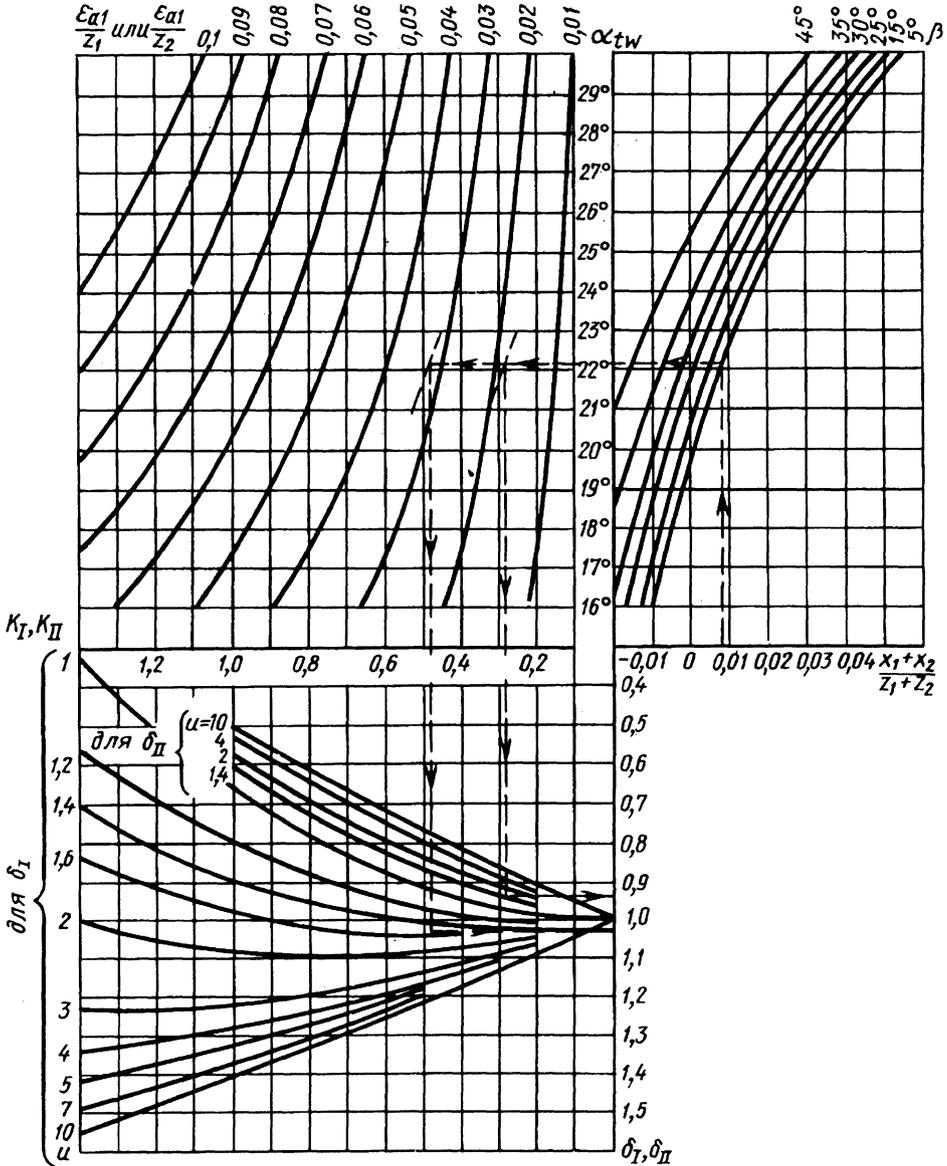
Рис. 61. График для определения коэффициентов  $\delta_I$  и  $\delta_{II}$
