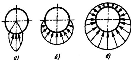
Рис. 22. Распределение нагрузок на тела качения:
