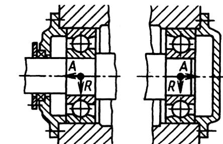
Радиально-упорные шарикоподшипники с узкими торцами наружных колец внутрь в сквозной расточке корпусов, регулируемые набором тонких металлических прокладок между крышками и торцами корпуса
