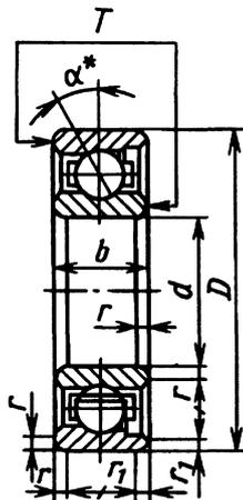
$\alpha^*$  — угол контакта, равный углу между линией действия результирующей нагрузки на тело качения и плоскостью, перпендикулярной оси подшипника.
