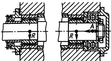
Игольчатые подшипники в комбинации с радиальным шарикоподшипником, разгруженным от внешних радиальных сил и несущим только осевую нагрузку переменного направления
