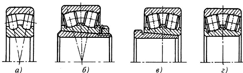
Рис. 16. Подшипники радиальные роликовые сферические исполнений:
