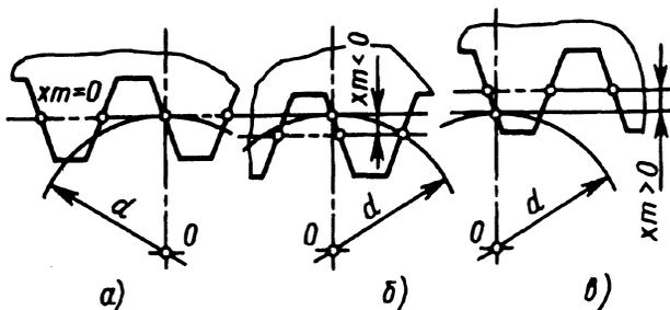
Рис. 5. Положение производящего реечного контура относительно заготовки:
