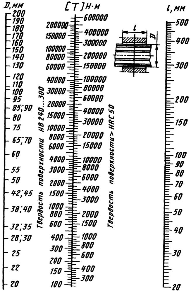
Испытание на скручивание вала с прямоугольными зубьями и плоским дном впадины показывает, что его прочность эквивалентна прочности гладкого вала, диаметр которого несколько меньше внутреннего диаметра шлицевого вала.
