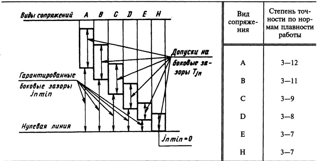
Примечание. Сопряжение вида В обеспечивает минимальную величину бокового зазора, при котором исключается возможность заклинивания стальной или чугунной передачи от нагрева при разности температур зубчатых колес и корпуса в 25 °С.
