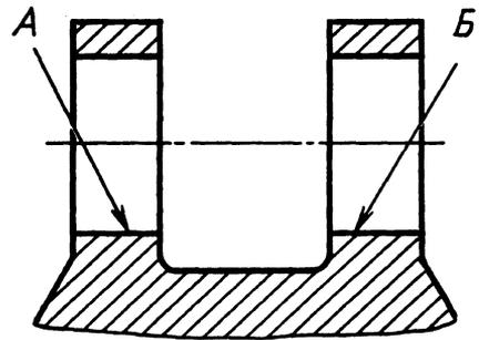
Рис. 5. Отклонение от соосности отверстия А относительно отверстия Б
