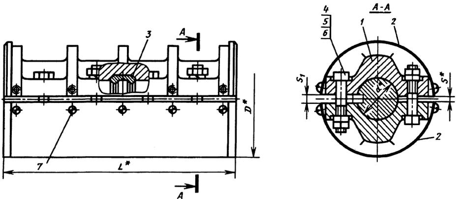
1 — полумуфта; 2 — полукожух; 3 — фиксирующие полукольца; 4 — болт по ГОСТ 7796—70; 5 — гайка по ГОСТ 5916—70; 6 — шайба по ГОСТ 6402—70; 7 — винт по ГОСТ 17473—80
