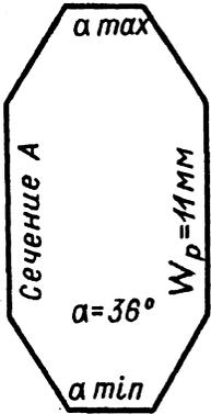
Рис. 7. Предельный угловой калибр для канавки шкива
