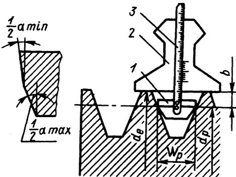
Рис. 9. Глубиномер для контроля угла канавки:
