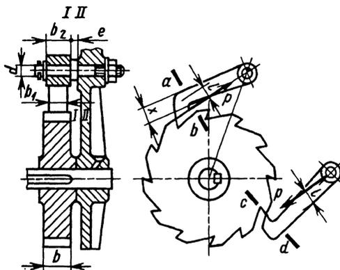
**Рис. 5. Схема к расчету храповиков**
