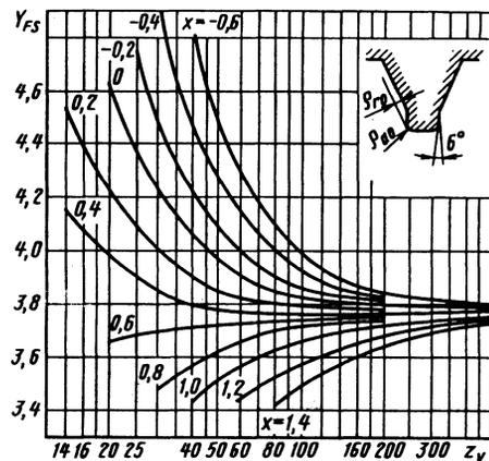
Рис. 53. Коэффициент, учитывающий форму зубьев, изготовленных инструментом с протуберанцем
