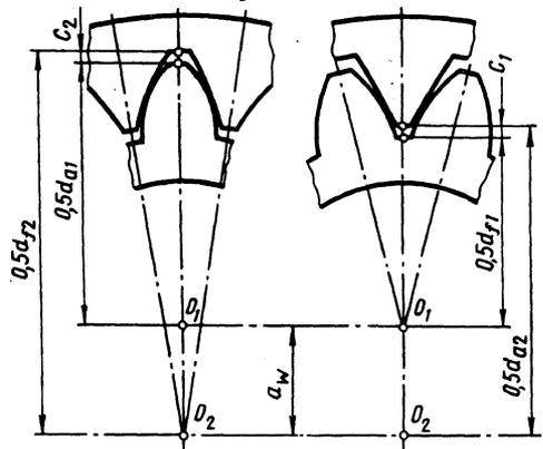
Рис. 19. К определению параметров во внутреннем зацеплении
