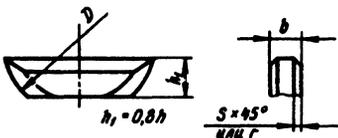
Допускается притупление острого угла фаской или радиусом до  $0,1 b$
