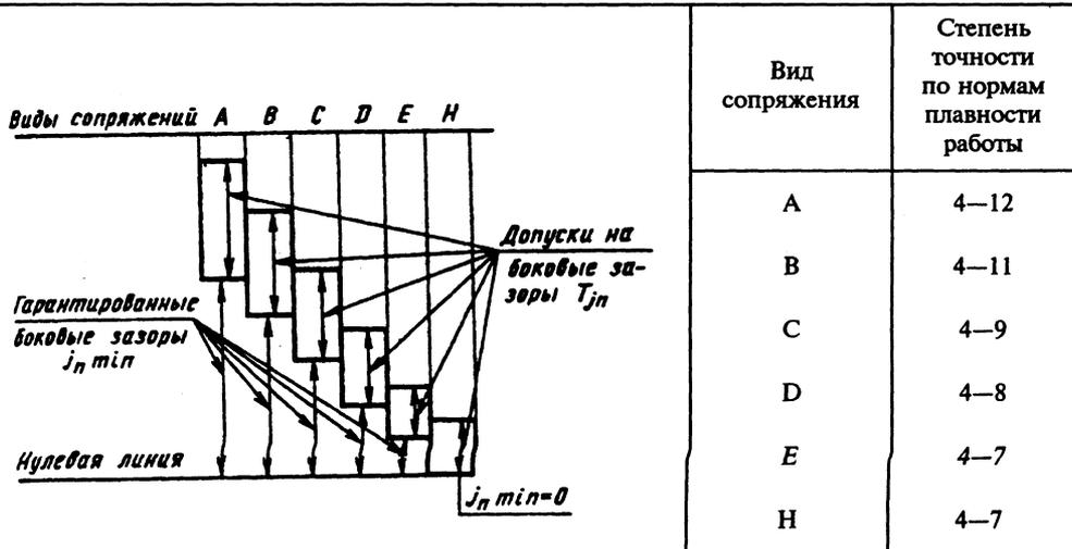
Примечание. Сопряжение вида В обеспечивает минимальную величину бокового зазора, при котором исключается возможность заклинивания стальной или чугунной передачи от нагрева при разности температур зубчатых колес и корпуса (чугунного или стального) в 25°С.
