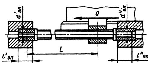
Рис. 2. Схема и данные для расчета на устойчивость
