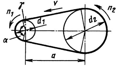
Рис. 12. Схема для расчета ременной передачи
