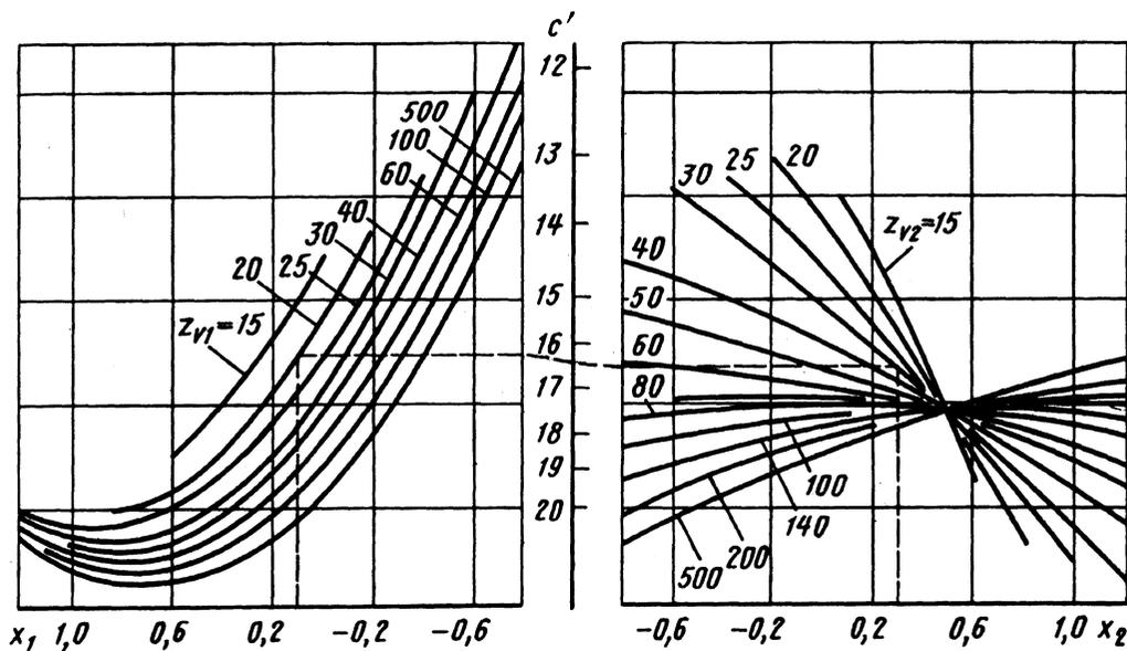
Рис. 45. Удельная нормальная жесткость пары зубьев  $c'$
