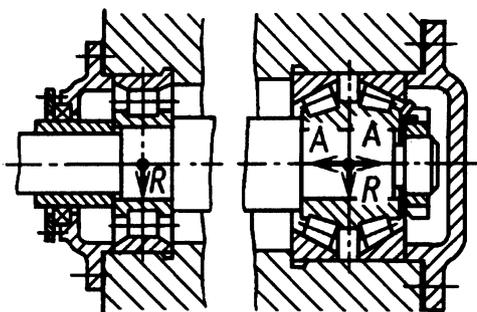
Парный комплект конических роликоподшипников в комбинации с радиальным роликоподшипником. Исключается возможность заклинивания подшипников при температурных изменениях длины вала вследствие обеспечения свободного осевого перемещения внутреннего кольца левого подшипника вместе с роликами относительно наружного (плавающая опора)
