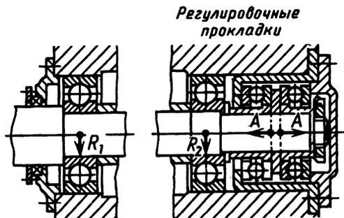
Комбинация двойного упорного и радиального шарикоподшипников в общей сквозной расточке корпуса. Упорные подшипники воспринимают только осевую нагрузку переменного направления, а радиальный — только радиальную
