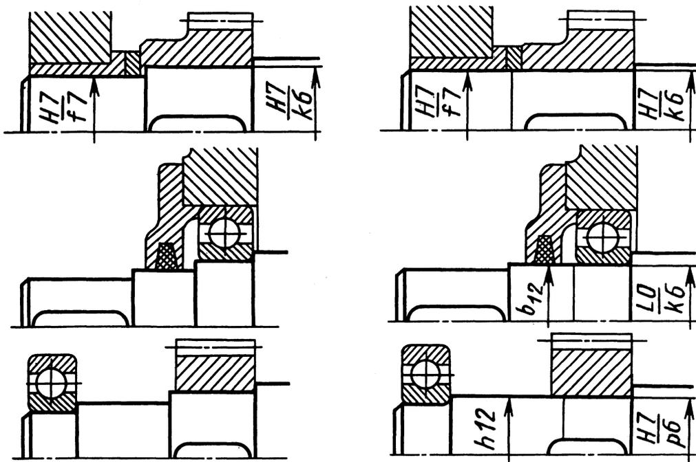
Рис. 17. Пример устранения переходных уступов на валах:
