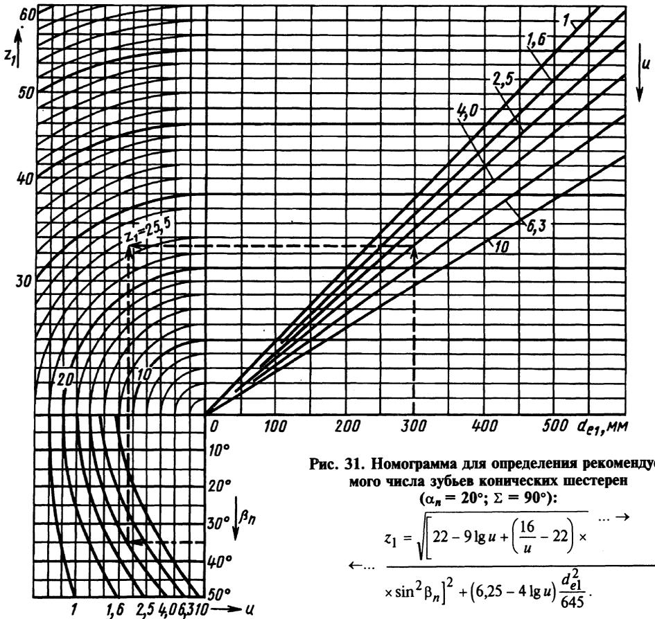
Рис. 31. Номограмма для определения рекомендуемого числа зубьев конических шестерен ( $\alpha_n = 20^\circ; \Sigma = 90^\circ$ ):
