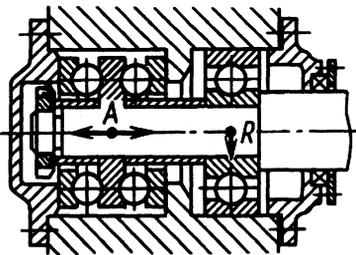
Комбинация двойного упорного и радиального шарикоподшипников. Упорный подшипник воспринимает только осевые нагрузки переменного направления, а радиальный — только радиальные. Осевые зазоры в упорном подшипнике регулируют набором прокладок между крышкой и корпусом
