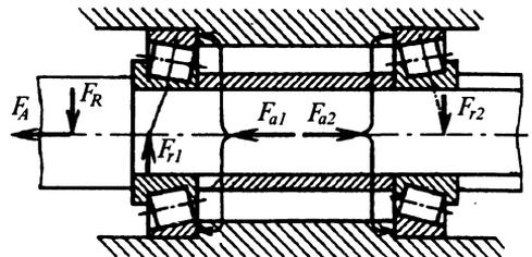
Рис. 26. Схема нагружения вала и опор с радиально-упорными регулируемыми подшипниками
