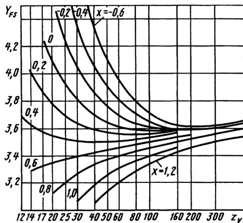
Рис. 52. Коэффициент, учитывающий форму зуба и концентрацию напряжений:
