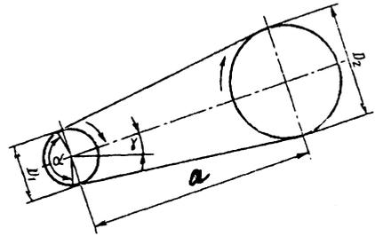
**Рис. 2. Основные геометрические данные для расчета передачи**
