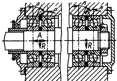
Сдвоенные радиально-упорные шарикоподшипники с установкой между ними комплектных колец (или набора прокладок) разной толщины, с помощью которых осу-
