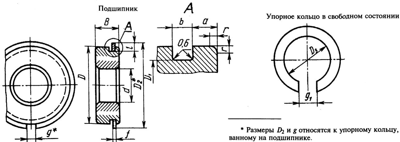
\* Размеры  $D_2$  и  $g$  относятся к упорному кольцу, смонтированному на подшипнике.
