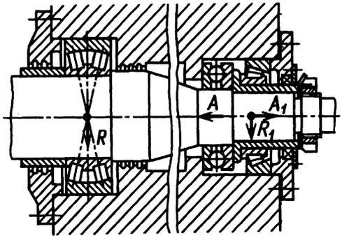
Комбинация конического роликоподшипника с упорным шарикоподшипником, воспринимающим значительные осевые нагрузки одностороннего направления при небольших частотах вращения. Конический роликоподшипник может воспринимать кроме значительных радиальных небольшие осевые нагрузки противоположного направления. Зазоры в обоих подшипниках выбираются при помощи торцевой крышки и набора регулировочных прокладок между крышкой и корпусом
