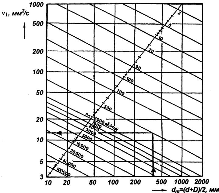
Рис. 40. Номограмма для определения вязкости  $\nu_1$  масла при рабочей температуре по среднему диаметру  $d_m$  подшипника и частоте  $n$  его вращения
