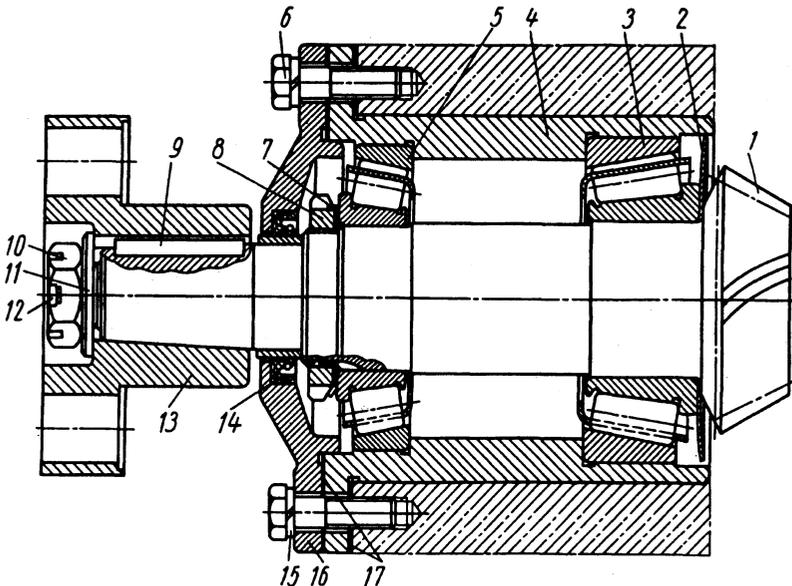
**Рис. 42. Конструкция узла вал-шестерни с круговым зубом:**
