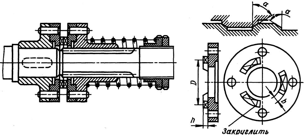
Рис. 8. Предохранительная пружинно-кулачковая муфта
