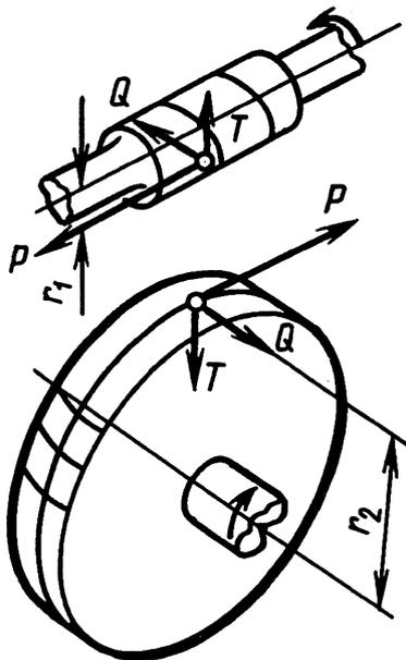
Окружная сила  $Q$  червяка определяется как сила  $P$  для цилиндрических зубчатых колес. Коэффициент трения для пары сталь - бронза  $f = 0,02 + 0,03$ , для пары чугун - чугун  $f = 0,1$ .
