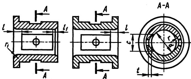
Маслоподводящие карманы, проточки и отверстия не следует размещать в нагруженной зоне подшипника как на поверхности трения, так и на поверхности контакта
