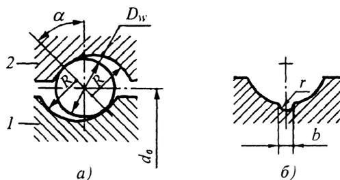
Рис. 1. Основные параметры полукруглого профиля резьбы
