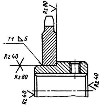
Рис. 2. Конструкция сварной звездочки
