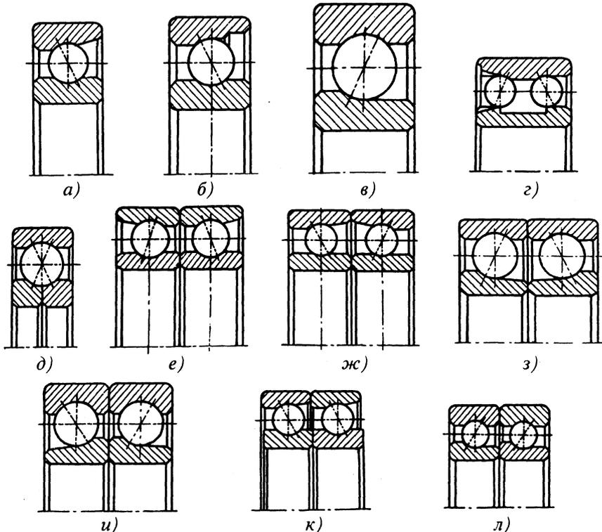
**Рис. 18. Подшипники радиально-упорные шариковые исполнений:**
