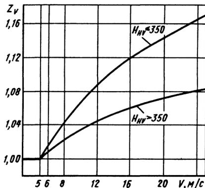
Рис. 48. График для определения коэффициента  $Z_v$
