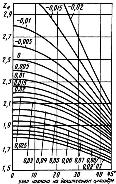
Рис. 43. График для определения коэффициента  $Z_H$
