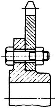
Рис. 1. Конструкция составной звездочки
