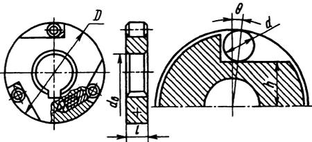
**Рис. 6. Узел ненормализованных обгонных муфт**
