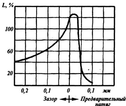
Рис. 23. Влияние зазоров и натягов на ресурс ( $L$  - ресурс в процентах от расчетного)
