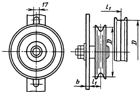
Рис. 15. Натяжное приспособление кулисного типа
