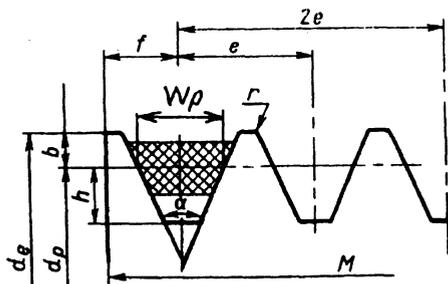
$W_p$  — расчетная ширина канавки шкива;  $b$  — глубина канавки над расчетной шириной;  $d_p$  — расчетный диаметр шкива;  $h$  — глубина канавки ниже расчетной ширины;  $e$  — расстояние между осями канавок;  $f$  — расстояние между осью крайней канавки и ближайшим торцом шкива;  $\alpha$  — угол канавки шкива;  $d_e$  — наружный диаметр шкива;  $r$  — радиус закругления верхней кромки канавки шкива;  $M$  — ширина шкива.
