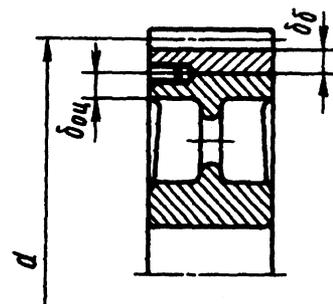
Рис. 23. Конструкция бандажированных цилиндрических колес
