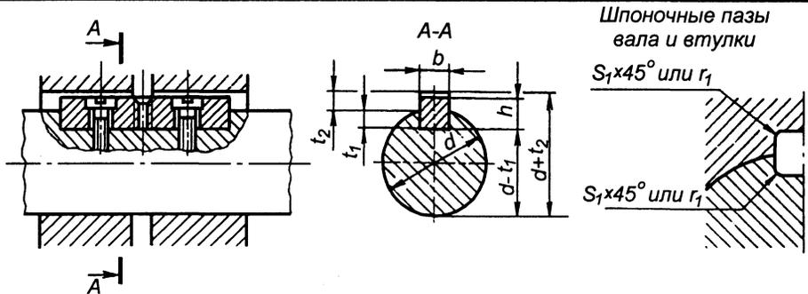
На рабочем чертеже должен проставлять один размер для вала  $t_1$  (предпочтительный вариант) или  $(d - t_1)$  и для втулки  $(d + t_2)$ .
