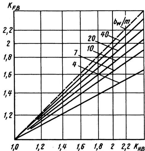
Рис. 51. График для определения коэффициента  $K_{FB}$
