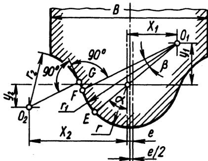
Профиль зуба звездочек, получаемый методом деления при нарезании дисковыми фрезами, полностью соответствует теоретическому (исходному) профилю только при расчетном числе зубьев  $z_1$  данной группы.
