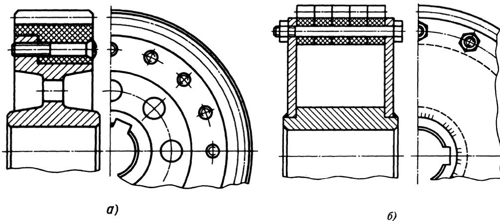
Рис. 25. Конструкция армированных зубчатых колес:
