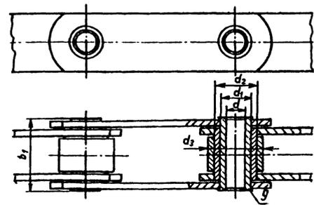
1 — валик; 2 — втулка; 3 — ролик; 4 — внутренняя пластина; 5 — наружная пластина;
