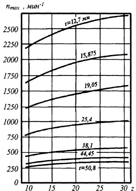
Рис. 1. Зависимости предельно допустимой частоты вращения звездочки от числа ее зубьев и шага цепи
