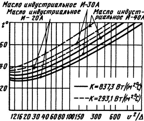
Рис. 1. Коэффициент теплоотдачи  $K$ , отнесенный к единице площади проекции шейки вала; для подшипников, расположенных в коробках скоростей и обдуваемых, принято  $K = 837,3\ \text{Вт}/(\text{м}^2\cdot^\circ\text{C})$ , для отдельно расположенных подшипников  $K = 293,1\ \text{Вт}/(\text{м}^2\cdot^\circ\text{C})$
