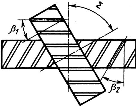
Рис. 17. Винтовые передачи, зацепляющиеся под углом
