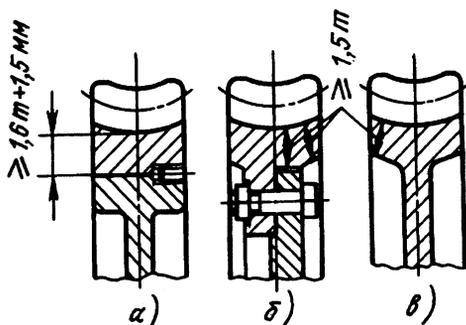
Рис. 67. Конструкция обода червячных колес
