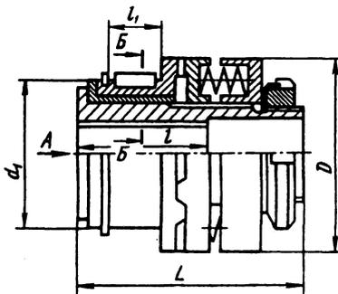
Предохранительная шариковая муфта по ГОСТ 15621-77
