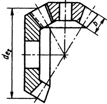
Допускается применять ширины зубчатых венцов, определяемые расчетным путем по табл. 70 и 71.
