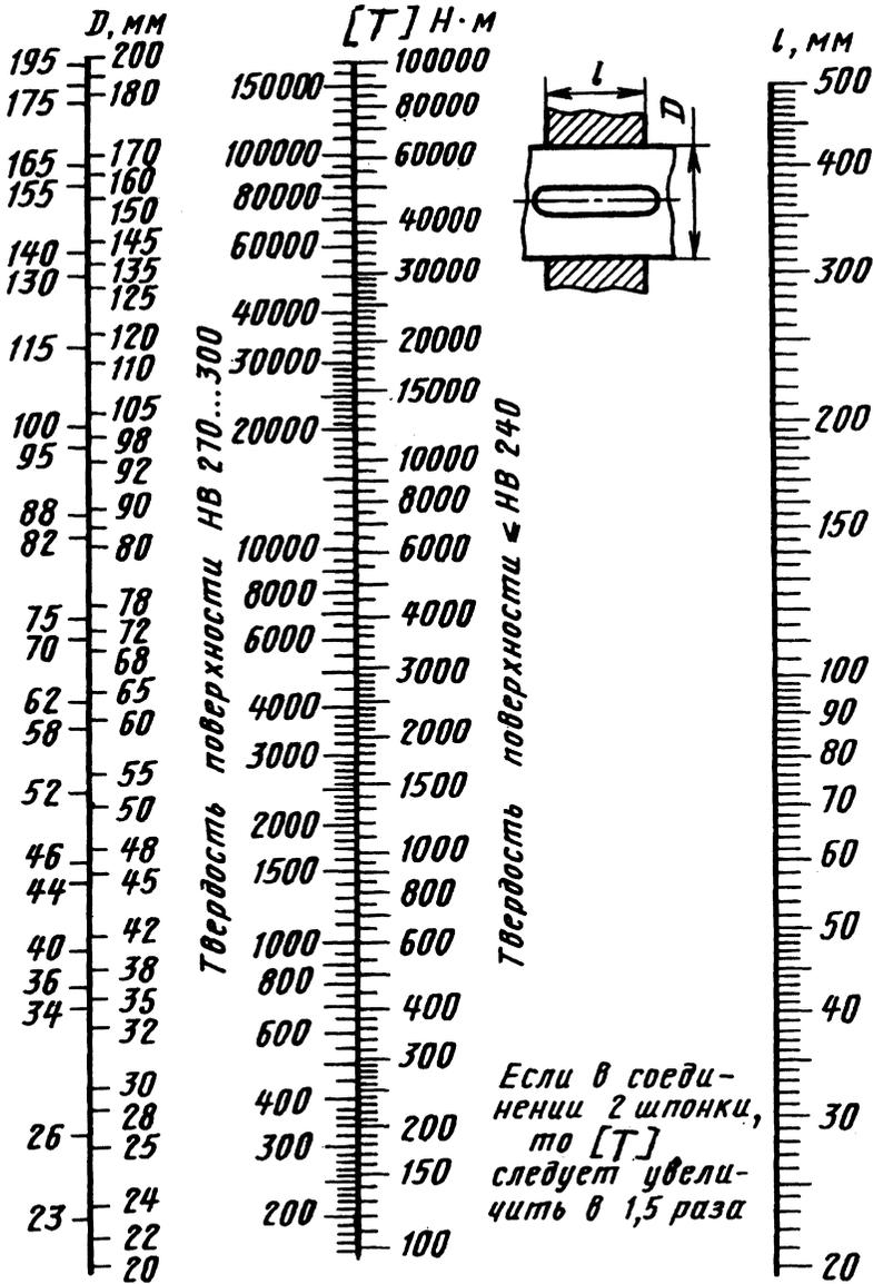
Рис. 19. Номограмма для определения параметров шпоночного соединения
