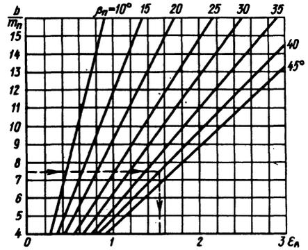
Рис. 32. График для определения коэффициента осевого перекрытия
