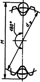
← Рис. 13. Размеры по роликам при четном числе зубьев
