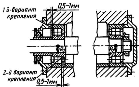
Радиальные роликоподшипники в общей сквозной расточке корпусов
