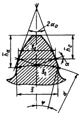
Рис. 10. Толщина зуба по постоянной хорде и высота до постоянной хорды в нормальном сечении
