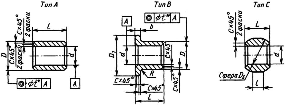
\*  $t = IT8$  при  $D \leq 50$  мм;  $t = IT9$  при  $D > 50$  мм.
