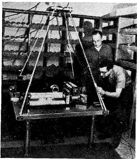
Рис. 10.28. Точный прибор, в котором для проведения релятивистского оптического опыта используются два лазера. Прибор помещен в бывшем винном погребе в Раунд Хилл, штат Массачусетс. На снимке с прибором работают Чарльз Таунс и Али Джаван.
