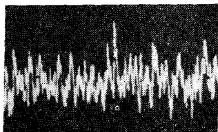
Рис. 1.27. Фотография шумов выходного напряжения, сделанная с помощью схемы, показанной на рис. 1.26.
