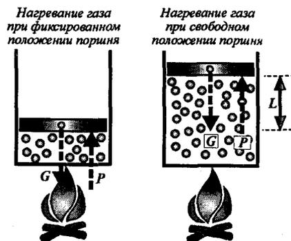
Рис. 4.16. Схема проведения опыта по определению механического эквивалента теплоты
