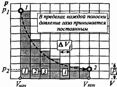
Рис. 4.11. График изотермического процесса расширения идеального газа
