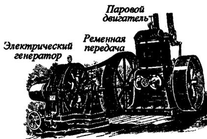
Рис. 1.15. Простейшая тепловая станция
