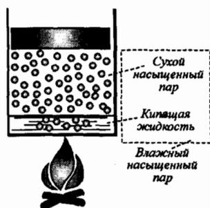
Рис. 6.13. Образование влажного насыщенного пара
