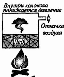
Рис. 6.3. Нагревание льда при пониженном давлении окружающей среды
