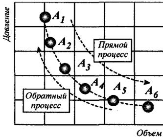
Рис. 4.3. График протекания обратимого процесса
