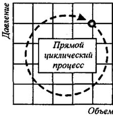
Рис. 4.5. Условная схема протекания прямого кругового процесса
