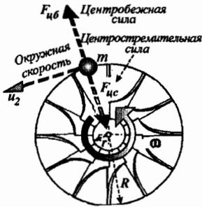
Рис. 7.35. Действие центробежной силы на частицу газа во вращающемся колесе компрессора
