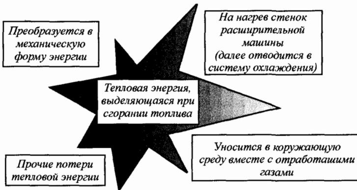
Рис. 10.18. Распределение потоков тепловой энергии, выделяющейся при сгорании топлива в цилиндре расширительной машины
