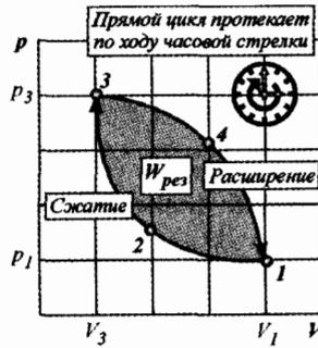
Рис. 8.5. Условная схема протекания прямого цикла
