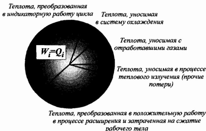
Рис. 15.22. Условный тепловой баланс двигателя внутреннего сгорания
