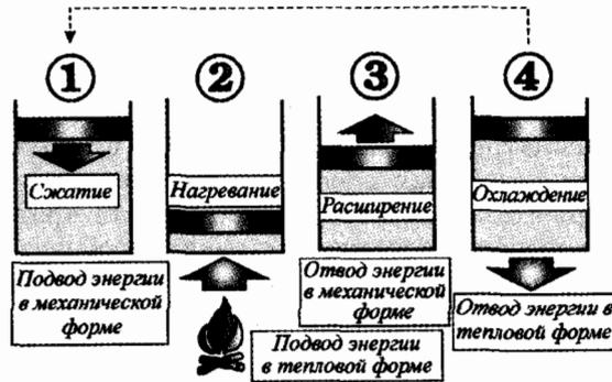
Рис. 8.7. Последовательность осуществления циклического процесса
