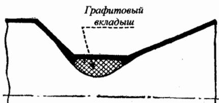
Рис. 15.83. Установка графитового вкладыша в сопле РДТТ
