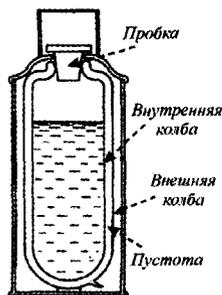
Рис. 8.40. Конструкция термоса (дьюара)
