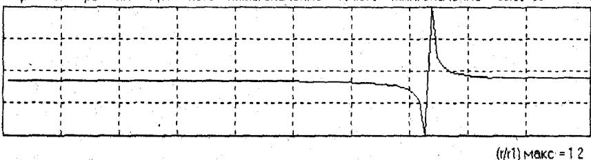
Рис. 2.4. Характер изменения безразмерного давления для двух близких к пограничному коллапсу случаев - до появления второго внутреннего экстремума ( $R/r_1 = 1.1$ ) и при наличии такового ( $R/r_1 = 1.015$ ).
