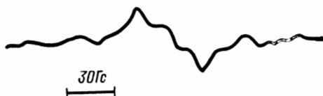
Рис. 7.12. Спектр ЭСР радикалов полиэтилена, полученных облучением полимера при  $-196^\circ\text{C}$  [32].
