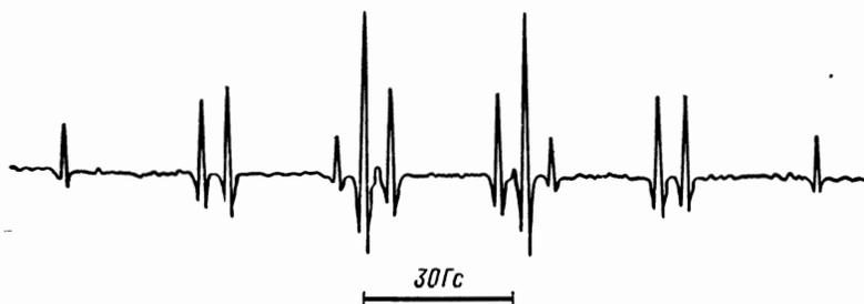
Рис. 7.11. Спектр ЭСР этильных радикалов, полученных при радиоллизе жидкого этана [13].
