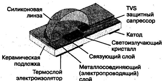
Рис. 4.21. Внутреннее строение светодиодов серии Luxeon Rebel (AllnGaP)
