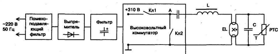
Рис. 3.13. Структурная схема электронного балласта
