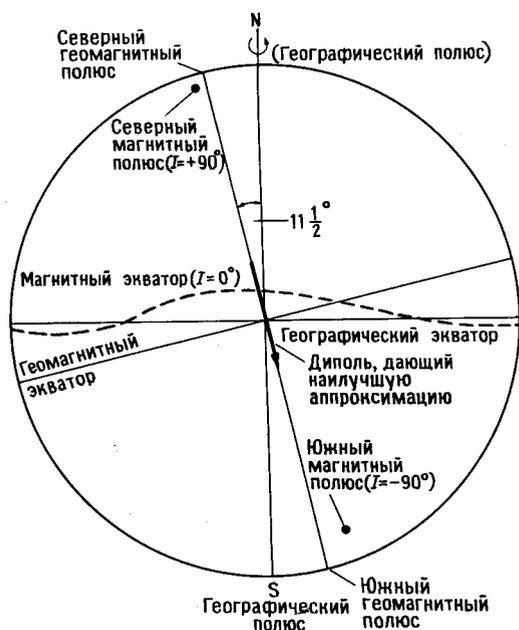
Рис. 3.14. Схематическое изображение различий между географическими, геомагнитными и магнитными полюсами и экваторами (McElhinny, 1973).
