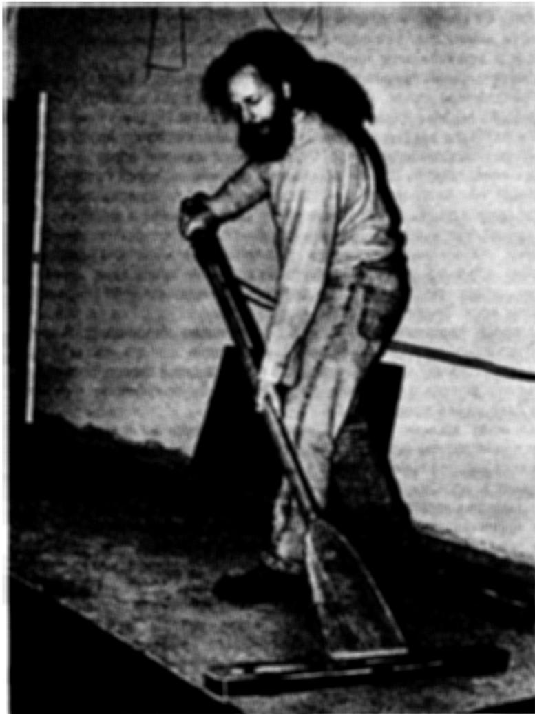
Рис. 8.6. Размагничивание листа трансформаторной стали с помощью большой переносной катушки. Эта же катушка использовалась для перемагничивания листов после сборки экранированной комнаты. Обмотка катушки состоит из 200 витков медной проволоки 18-го калибра и подключается к сети переменного тока с напряжением 120 В. Для размагничивания труднодоступных мест комнаты применялись переносные катушки меньших размеров.
