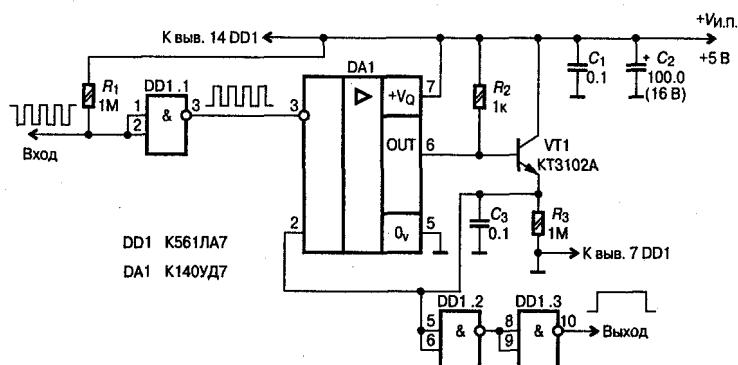
Рис. 1.20. Электрическая схема интегратора импульсов
