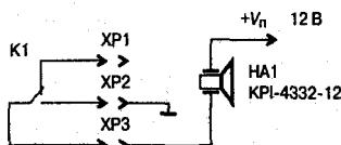
Рис. 1.12. Электрическая схема внешних подключений к датчику
