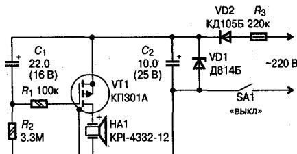
Рис. 1.19. Электрическая схема хладосберегающего звукового сигнализатора
