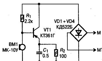
Рис. 3.4. Электрическая схема устройства доработки ТА на одном транзисторе
