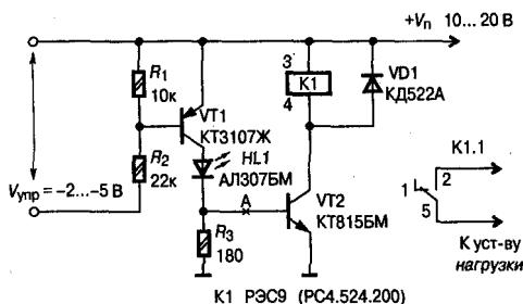
Рис. 4.1. Электрическая схема узла усилителя тока
