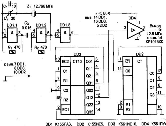
Рис. 2.2. Электрическая принципиальная схема узла нового опорного делителя
