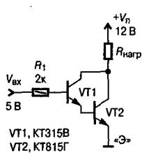
**Рис. 1.23.** Схема включения транзисторов по схеме Дарлингтона
