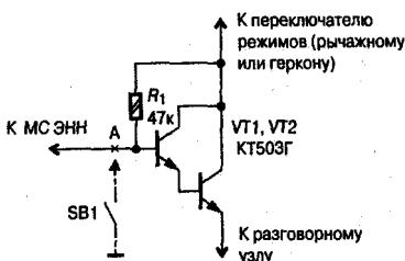
**Рис. 3.7.** Типовое соединение выхода МС ЭНН и импульсного транзисторного ключа
