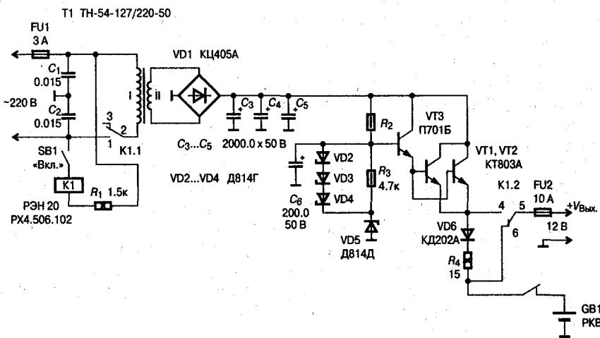
Рис. 1.3. Электрическая схема источника питания для радиостанции, рассчитанного на ток нагрузки до 10 А
