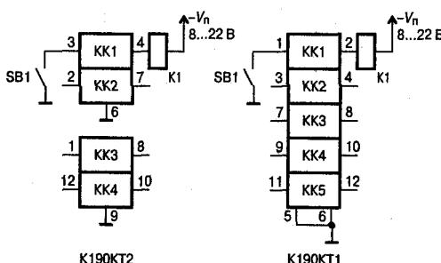
**Рис. 1.6.** Схема подключения аналоговых ключей микросборок K190KT2 и K190KT1
