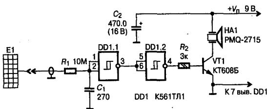
Рис. 4.11. Электрическая схема бесконтактного емкостного датчика
