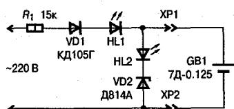
**Рис. 4.4.** Электрическая схема устройства зарядки малогабаритных аккумуляторов
