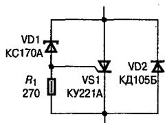
Рис. 1.28. Электрическая схема диодного триистора — аналога динистора
