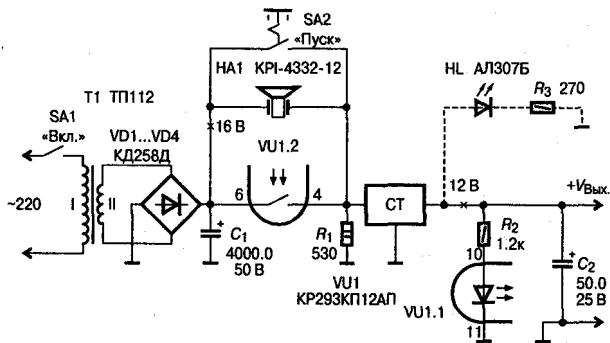
Рис. 1.2. Электрическая схема узла защиты ИП от короткого замыкания в нагрузке
