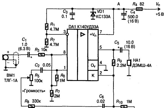
**Рис. 1.17.** Электрическая схема усилителя
