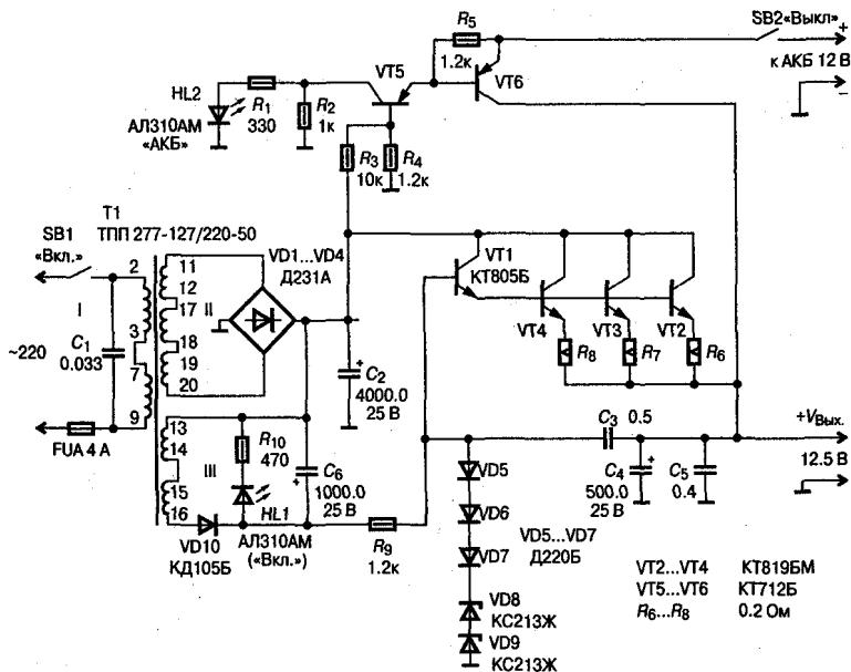
Рис. 1.1. Электрическая схема мощного источника питания для лаборатории радиолюбителя
