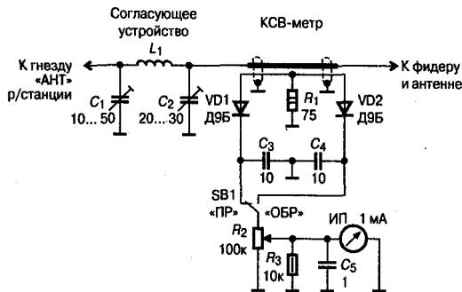
Рис. 2.9. Электрическая схема согласующего устройства с измерителем КСВ
