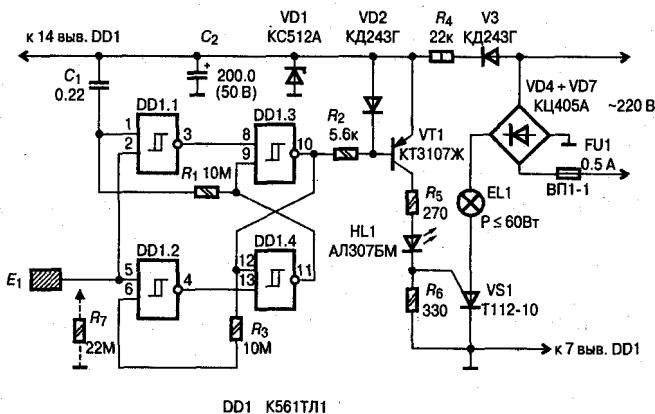
**Рис. 1.8.** Электрическая схема сенсорного устройства с узлом «щадящего» управления нагрузкой
