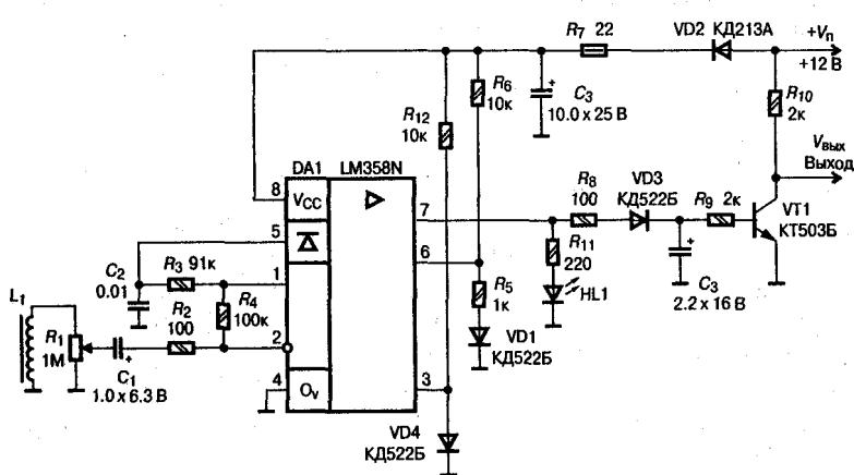
Рис. 4.10. Электрическая схема датчика сотрясения
