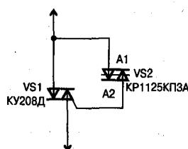
**Рис. 1.30.** Электрическая схема включения симметричного динистора КР1125КПЗА совместно с динистором КУ208 для увеличения мощности
