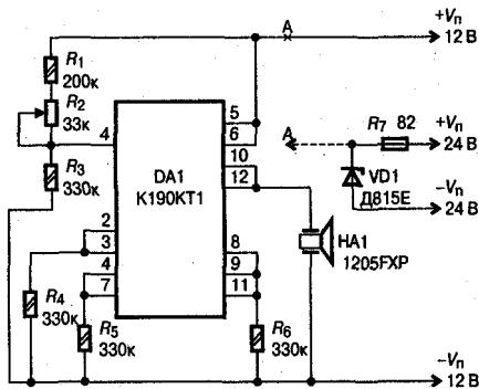
Рис. 1.7. Электрическая схема чувствительного сигнализатора
