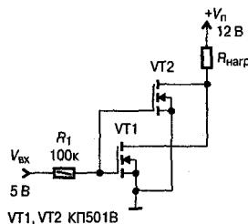
**Рис. 1.24.** Замена полевыми транзисторами составного транзистора по схеме Дарлингтона
