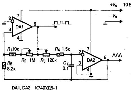
Рис. 1.14. Электрическая схема универсального генератора для настройки звуковой аппаратуры радиолюбителя
