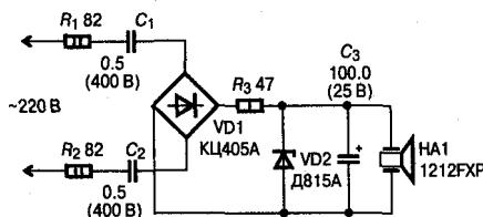
Рис. 1.18. Электрическая схема устройства звукового индикатора
