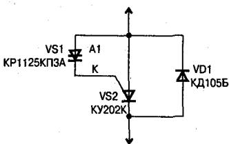
**Рис. 1.29.** Электрическая схема включения симметричного динистора КР1125КПЗА совместно с тиристором КУ202 для увеличения мощности
