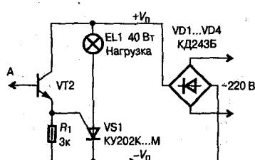
Рис. 4.2. Тиристорный узел управления нагрузкой в сети 220 В
