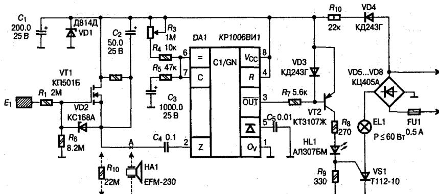
Рис. 1.9. Электрическая схема чувствительного сенсорного устройства с задержкой выключения
