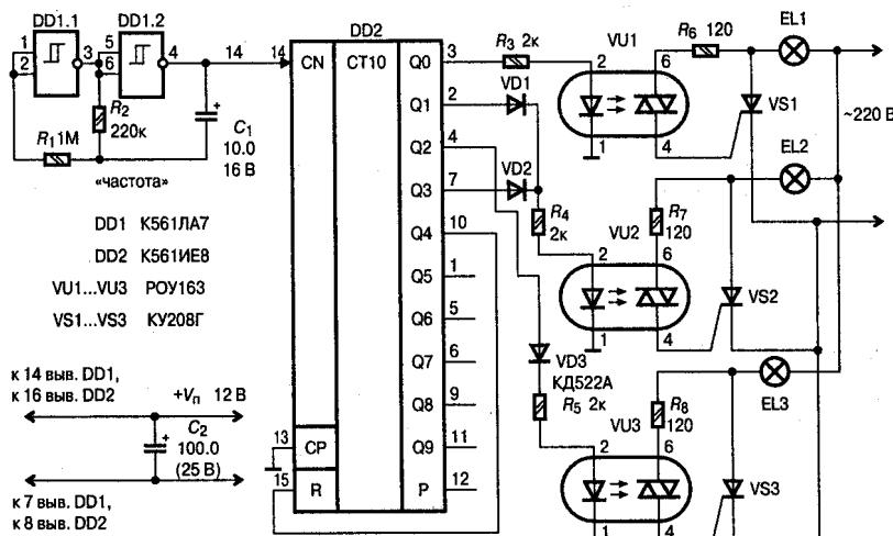
Рис. 1.15. Электрическая схема управления светофором
