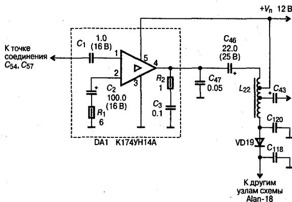
Рис. 2.5. Электрическая схема включения К174УН14А в плату радиостанции «Alan-18»
