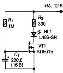
**Рис. 4.6.** Электрическая схема узла светового имитатора охранной сигнализации
