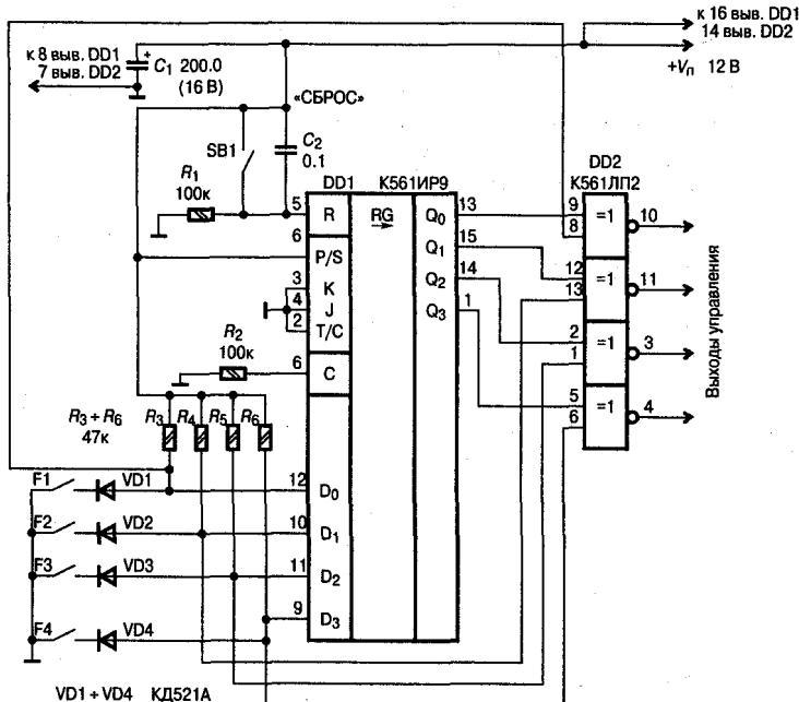
Рис. 4.5. Электрическая схема устройства сканирования с запоминанием состояния
