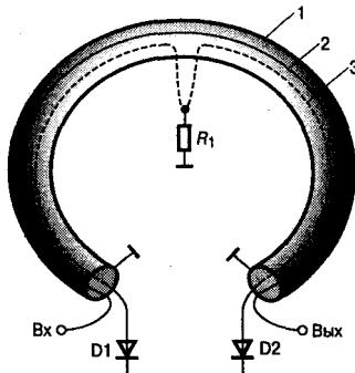
Рис. 2.10. Внешний вид загнутого «подковой» отрезка кабеля РК-50 для КСВ-метра
