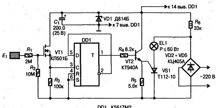
Рис. 1.10. Электрическая схема сенсора с триггером
