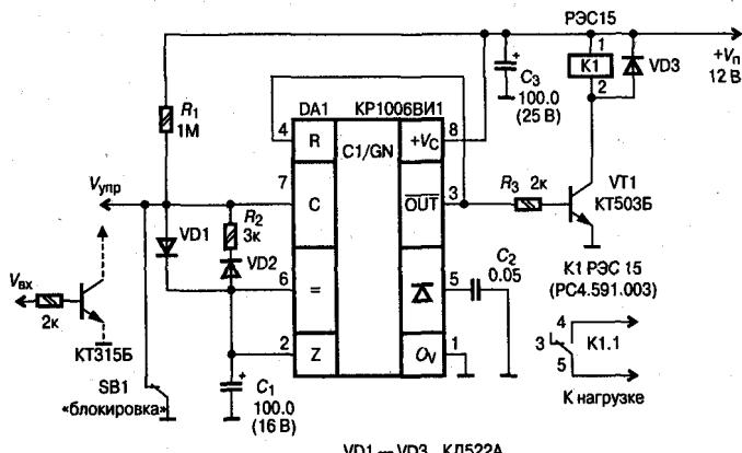
Рис. 1.31. Электрическая схема включения KP1006ВИ1 в режиме таймера
