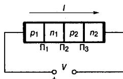
Рис. 1.26. Структурная схема прибора с четырьмя слоями
