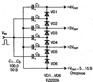
Рис. 1.5. Электрическая схема простого умножителя напряжения
