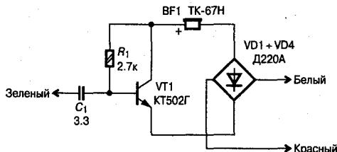
Рис. 3.6. Электрическая схема усилителя напряжения для ТА
