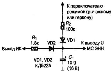
**Рис. 3.8.** Схема подключения дублирующего питания к МС ЭНН
