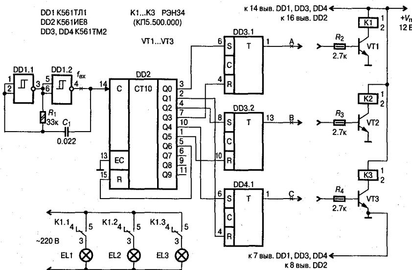
Рис. 1.11. Электрическая схема цифрового узла смещения фаз
