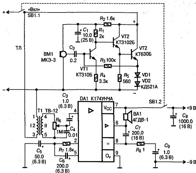
Рис. 3.2. Электрическая схема устройства громкой дистанционной связи
