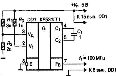
Рис. 2.8. Электрическая схема опорного генератора на микросхеме KP531ГГ1
