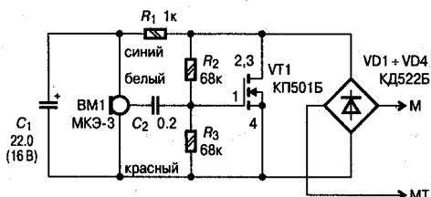
**Рис. 3.5.** Электрическая схема устройства с электретным микрофоном и полевым транзистором
