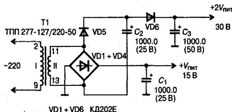
**Рис. 1.4.** Электрическая схема источника питания с базовым и удвоенным напряжением
