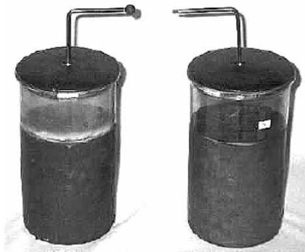
Рис. 3. Пара лейденских банок, изготовленная студентами в 1890–1910 гг. Банки имеют разные наконечники – сферический и игольчатый. Скорее всего они использовались при изучении электрических разрядов в воздухе
