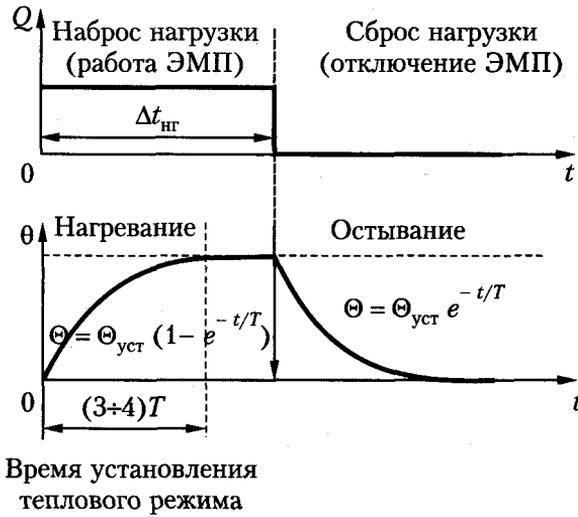
Рис. 1.9. Кривые нагревания и остывания идеального твердого тела
